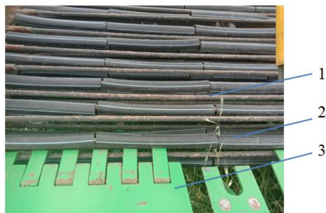
1– пруток; 2 – быстръемная трубка с продольным винтовым разрезом; 3 – лемех.
