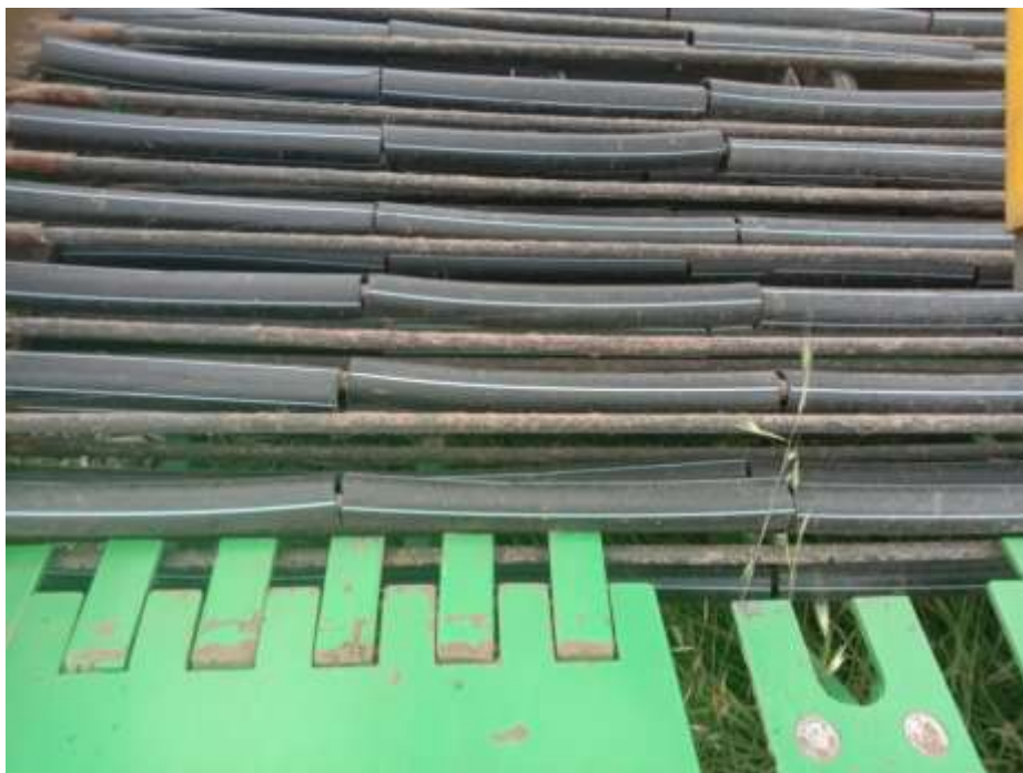
Рисунок 4.2– Вид сепарирующего элеватора с комбинированными прутками на картофелекопателе КТН-2В
