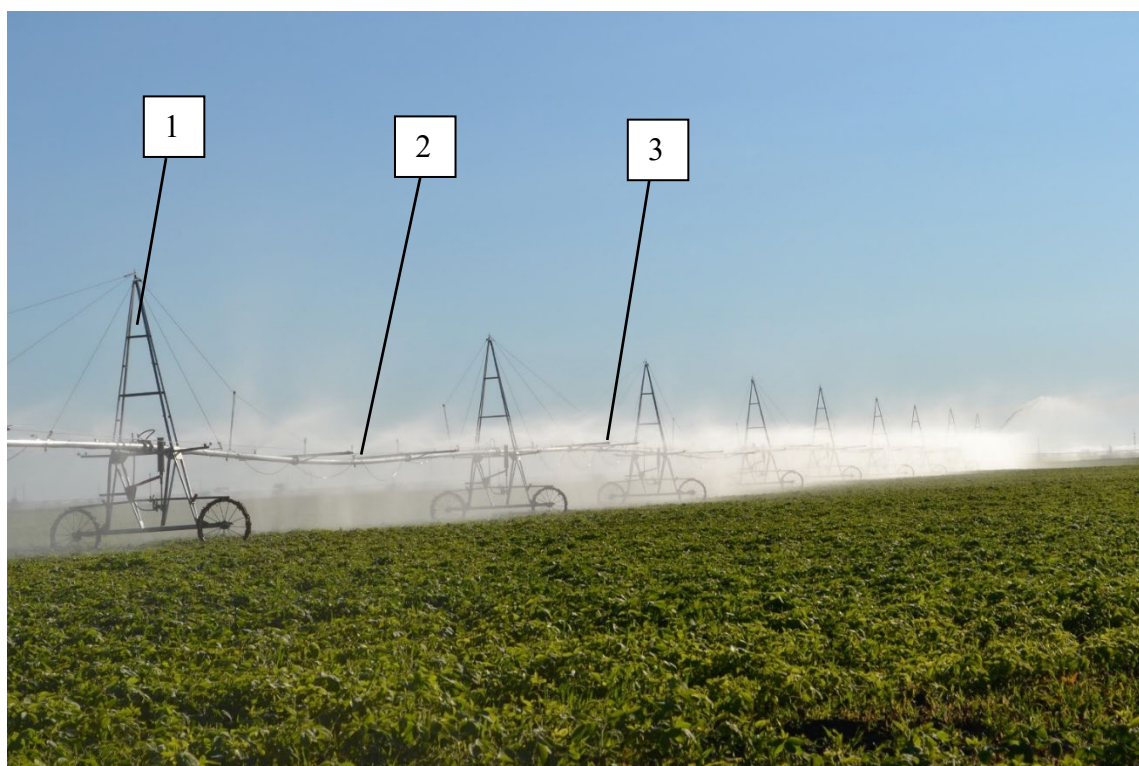
1 – самоходная тележка, 2 – водопроводящий пояс, 3 – дождевальный аппарат.
