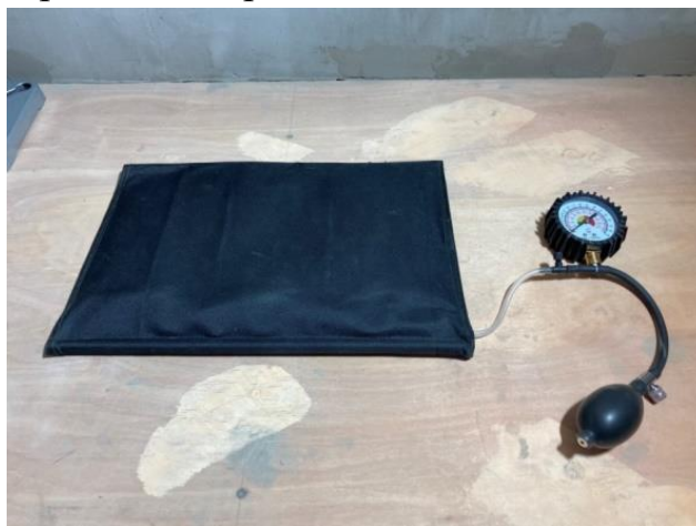
Рисунок 9 – Поперечная перегородка контейнера с устройством для нагнетания воздуха
