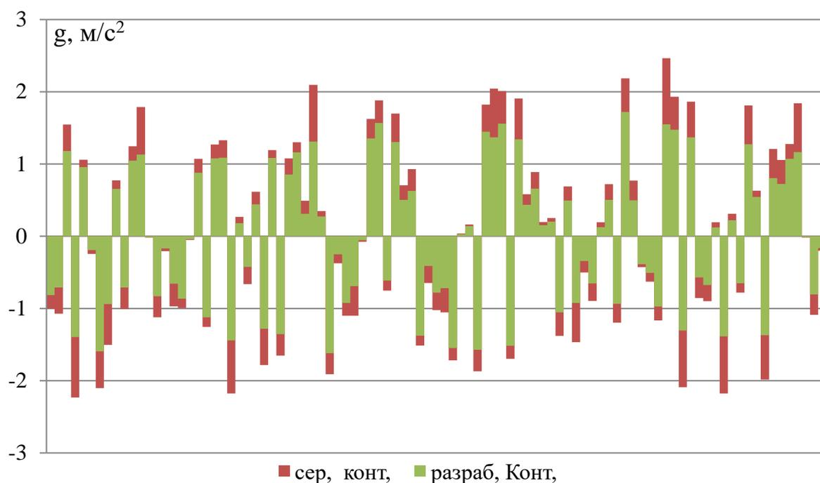
Рисунок 3.20 – Величина виброускорений колебаний груза при движении транспортного средства по дороге с асфальтобетонным покрытием при скорости 85 км/ч
