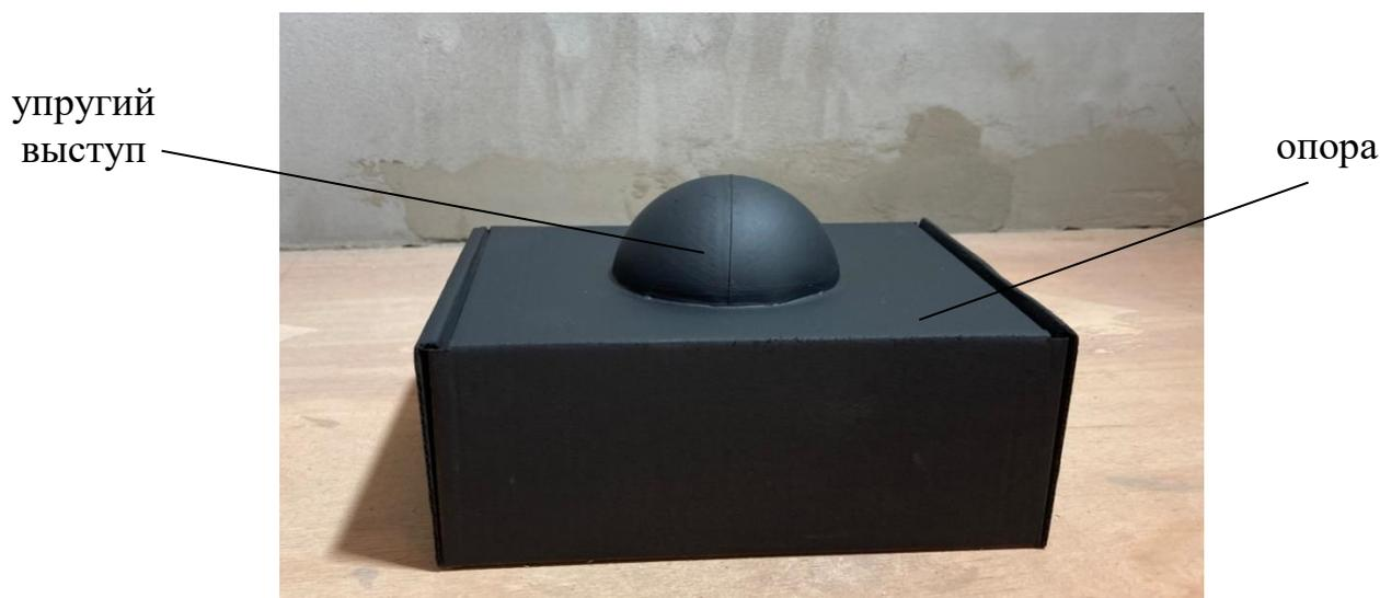
Рисунок 3.2 – Макет для определения модуля упругости одного выступа на дне контейнера
