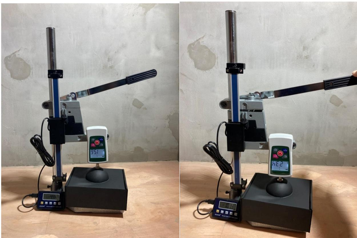
Рисунок 3.11 – Процесс измерения деформации упругого выступа предложенного контейнера
