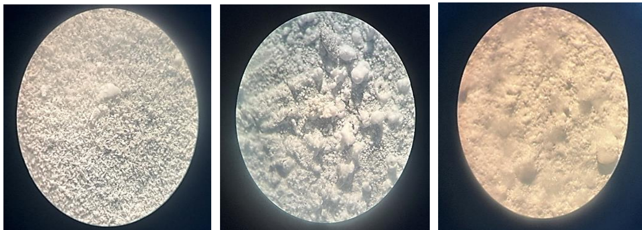
Рисунок 3.9 – Морфология осадков поверхности (4х) катодов после 10 часов электролиза постоянным током, проточный режим растворов:
