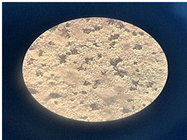
Рисунок 3.11 – Морфология осадков поверхности (4х) катодов после 12 часов электролиза переменным током; время прямого и обратного тока – 2 ч; проточный режим раствора:
