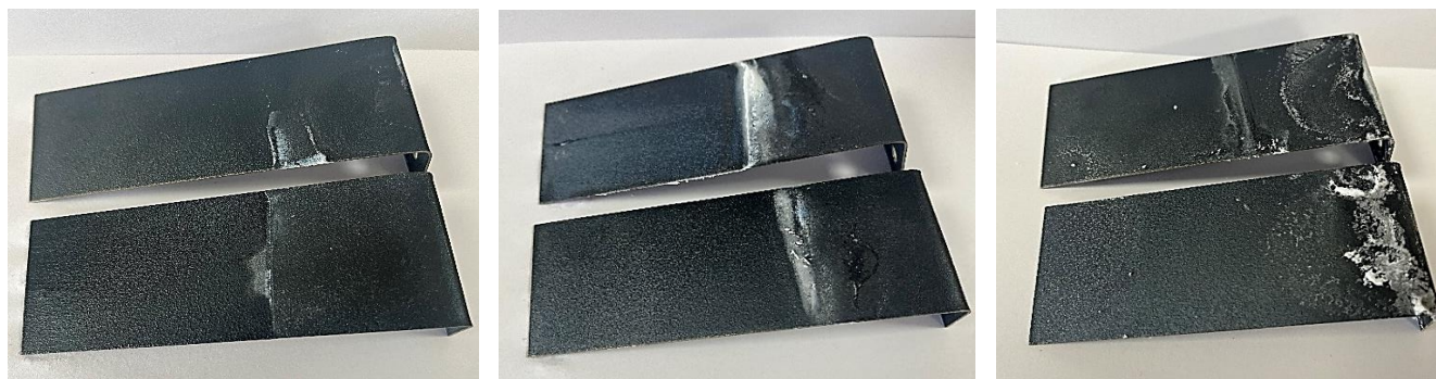
Рисунок 3.14 – Морфология осадков поверхности катодов после электролиза переменным током, циркуляционный режим растворов:
