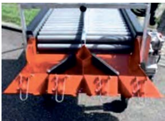
Рисунок 1.12 – Работа двухручьего роликового стола с сеткодержателями
