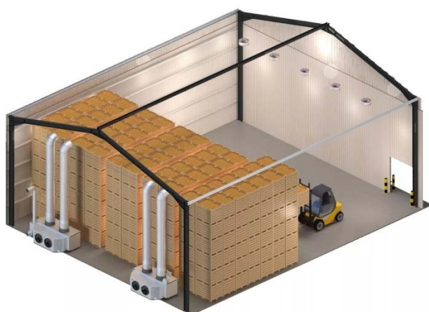
Рисунок 1.17 - Создание штабеля из контейнеров в картофелехранилище
