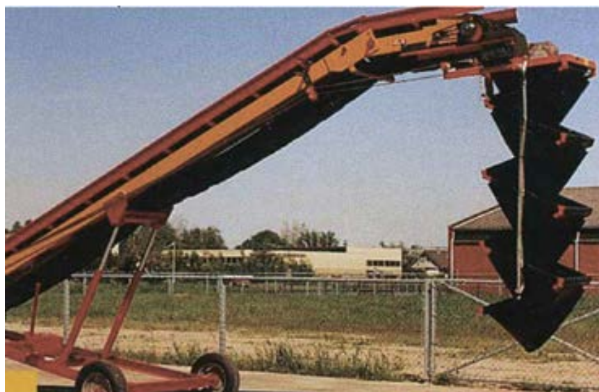
Рисунок 1.16 - Погрузчик с гасителем скорости падения клубней
