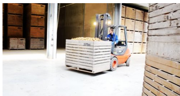
Рисунок 1.17 - Создание штабеля из контейнеров в картофелехранилище
