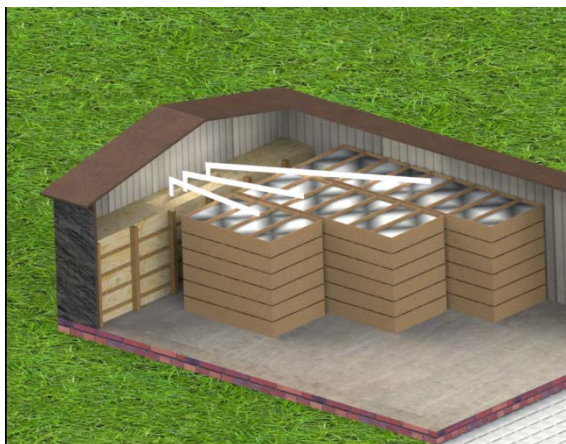
А - Объемное вентилирование контейнеров
