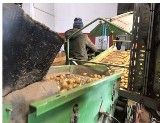
Рисунок 1.12 – Работа двухручьего роликового стола с сеткодержателями
