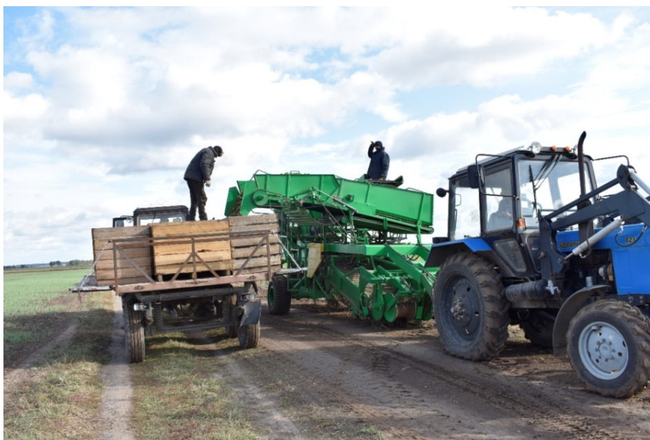
Рисунок 1.10 - Загрузка семенного материала в контейнеры во время уборки картофе́леуборочным комбайном
