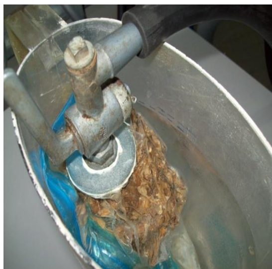
Рисунок 3.4- Блок с силосной массой в емкости с водой
