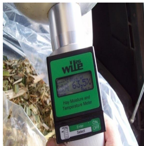
Рисунок 5.2- Определение влажности и начальной плотности силосной массы в мягком блоке перед его герметизацией
