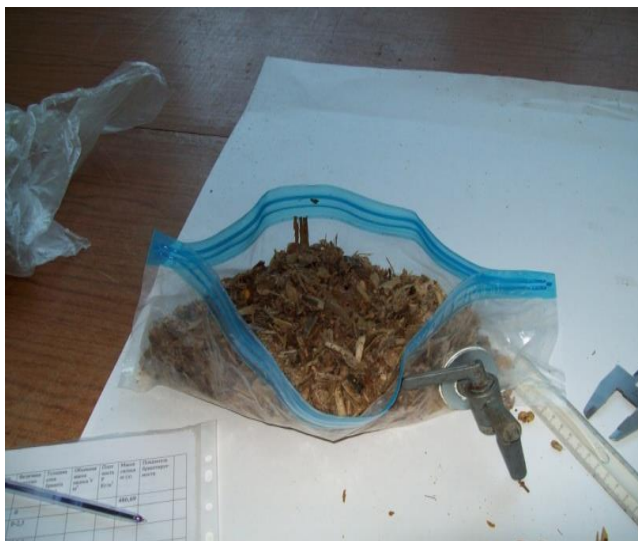
Рисунок 3.3- Закладка силосной массы в мягкий блок
