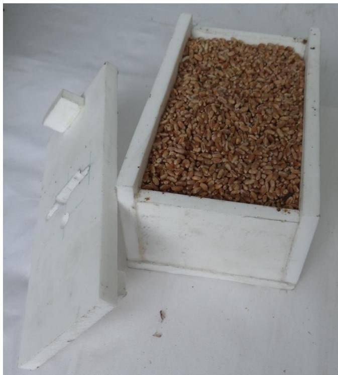
Рисунок 2.8 – Общий вид прибора для нахождения теплофизических свойств зернофуража методом плоского зонда
