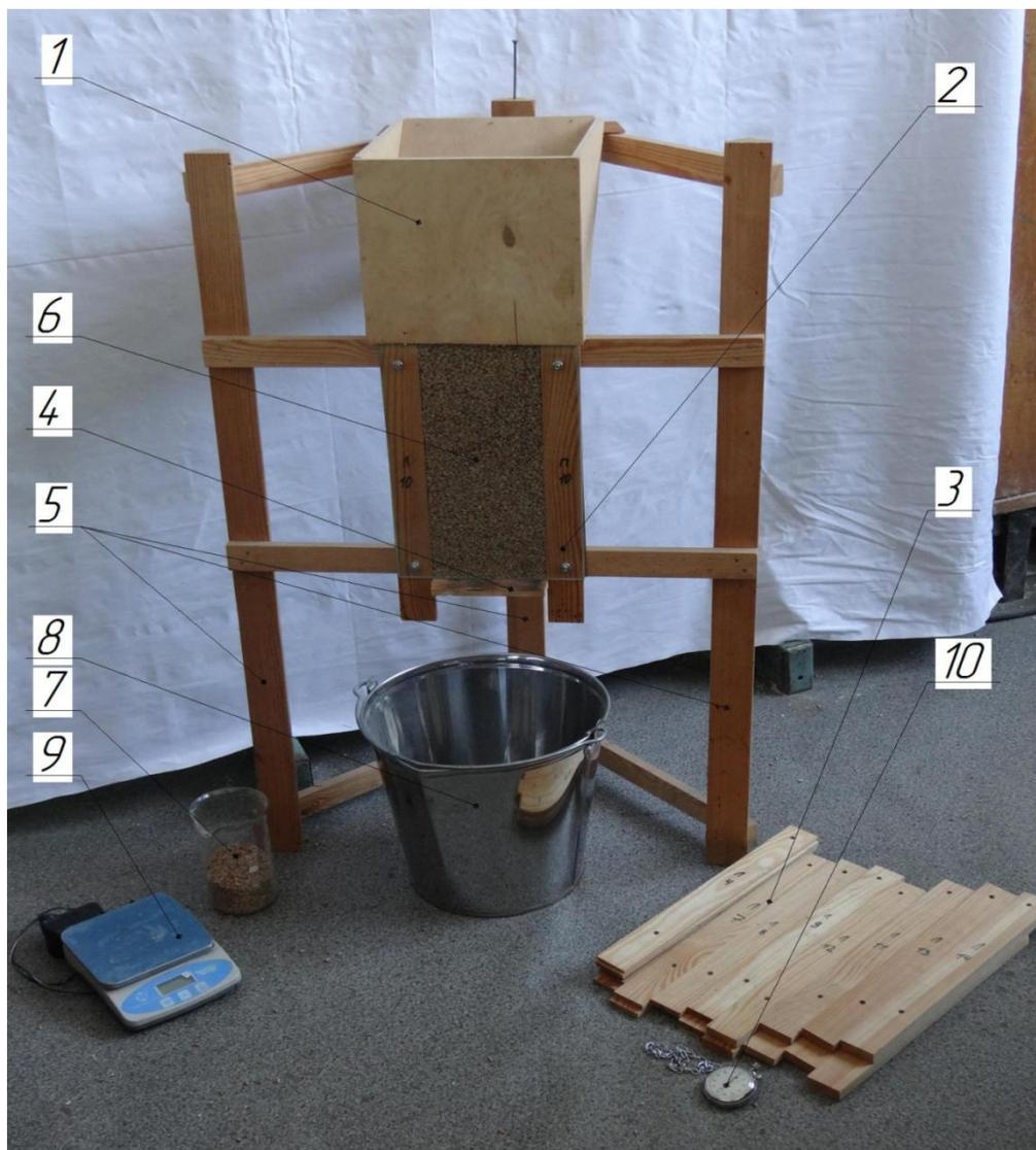
1 – бункер; 2 – кварцевое стекло; 3 – пластины для определения зазора; 4 – заслонка; 5 – опорные сойки; 6 – зерна в зазоре между кварцевым стеклом и металлическим листом; 7 – фуражное зерно; 8 – емкость для фуражного зерна; 9 – весы (ВК-1500.1); 10 – секундомер «556»;
