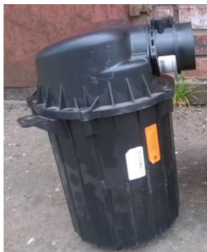
Рисунок 2.8 - Общий вид воздушного фильтра АК2705-1109010 в сборе.
