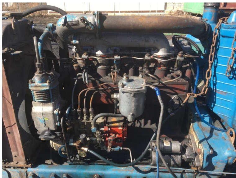
Рисунок 3.8. – Общий вид на топливное оборудование опытного трактора.
