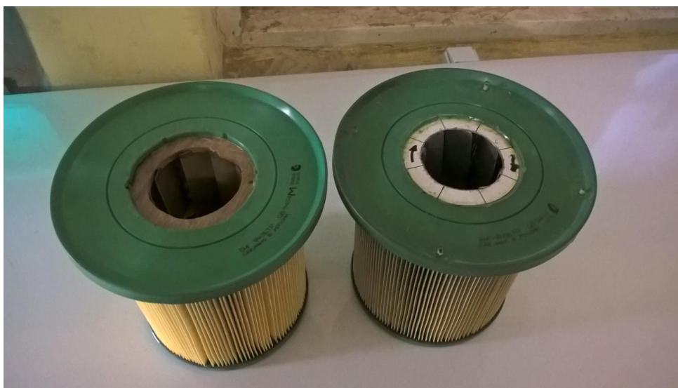
Рисунок 2.11. - Устройство воздухоподготовки, размещенное в предлагаемом воздушном фильтре.
