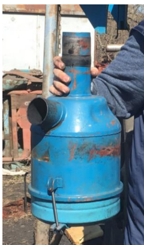
Рисунок 1.7. – Воздушный фильтр применяемый на тракторах МТЗ.
