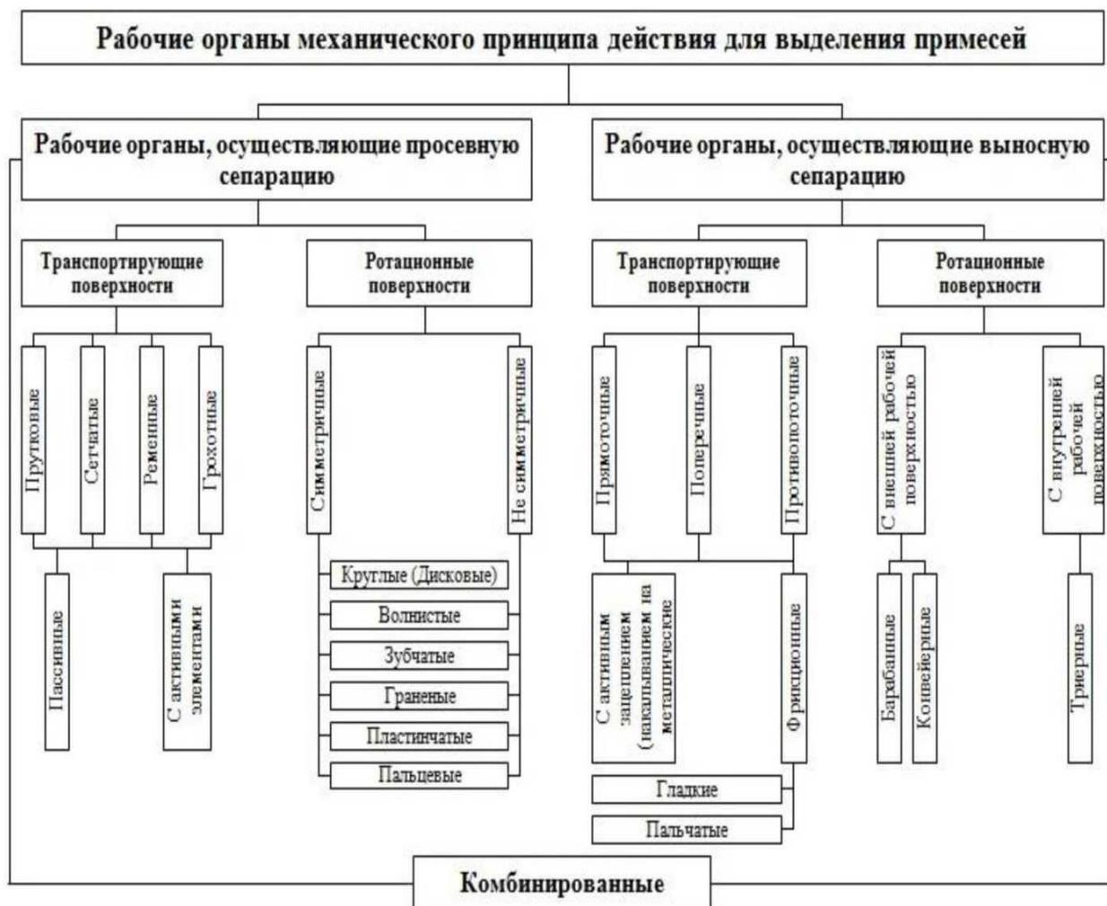
Рисунок 1.1-Классификация сепараторов механического принципа действия [16]
