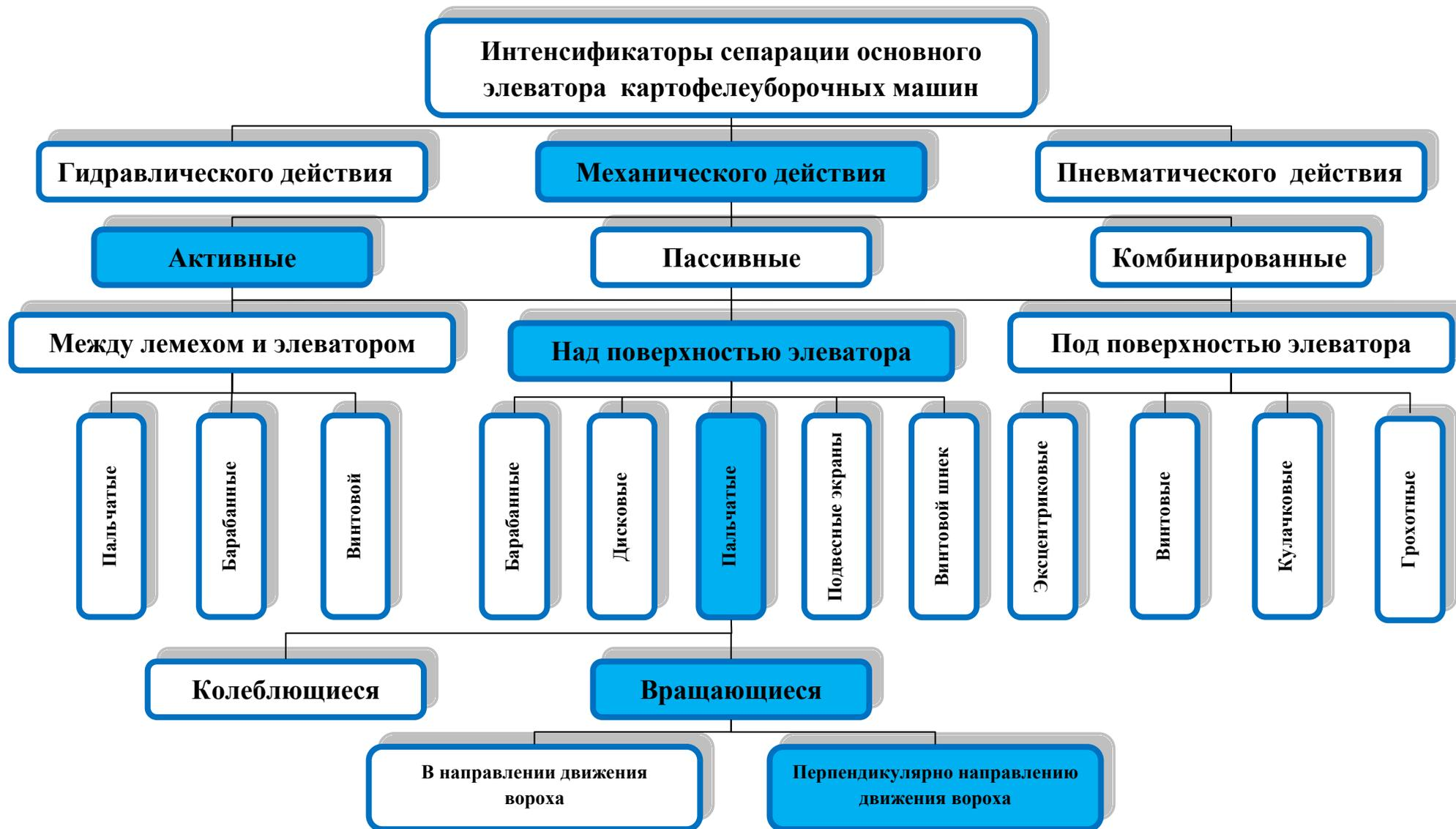
Рисунок 1.2 – Классификация интенсификаторов основного сепарирующего элеватора [127]
