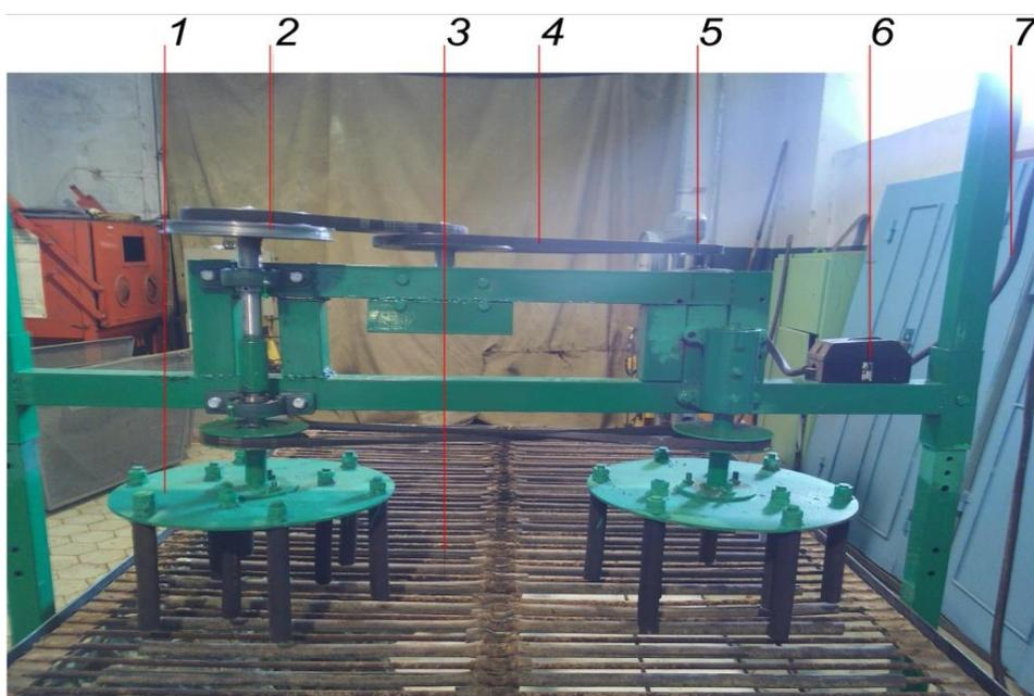
1-дисковый ворошитель; 2-шкив; 3-полотно элеватора; 4-ремень привода; 5-электродвигатель; 6-выключатель; 7-провод питания.
