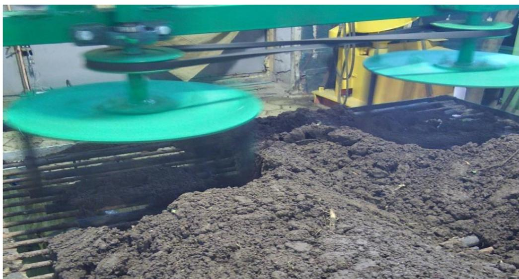
Рисунок 3.11 – Исследование эффективности функционирования дискового ворошителя
