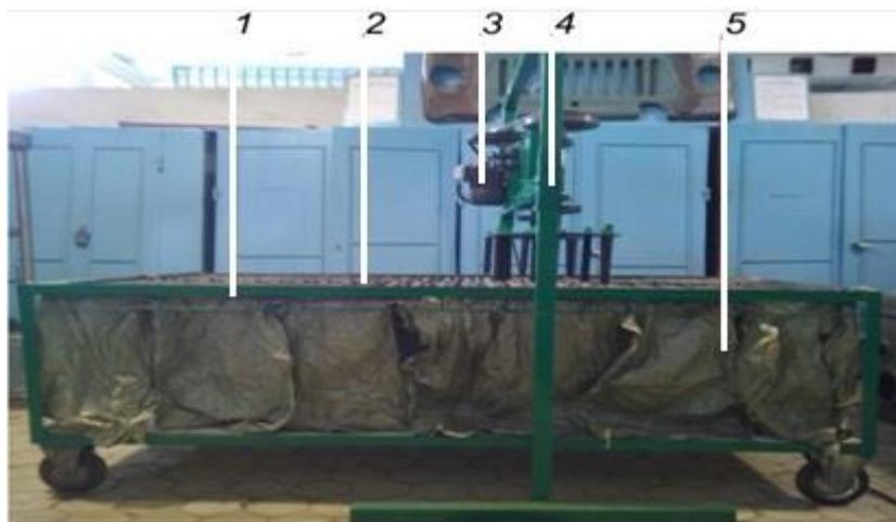
1 – тележка; 2 – полотно элеватора; 3 – электродвигатель; 4-арка;
