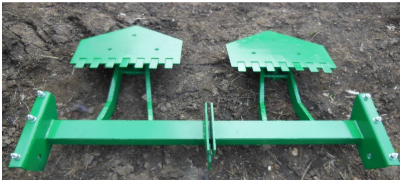
Рисунок 3.1 – Общий вид усовершенствованного подкапывающего устройства
