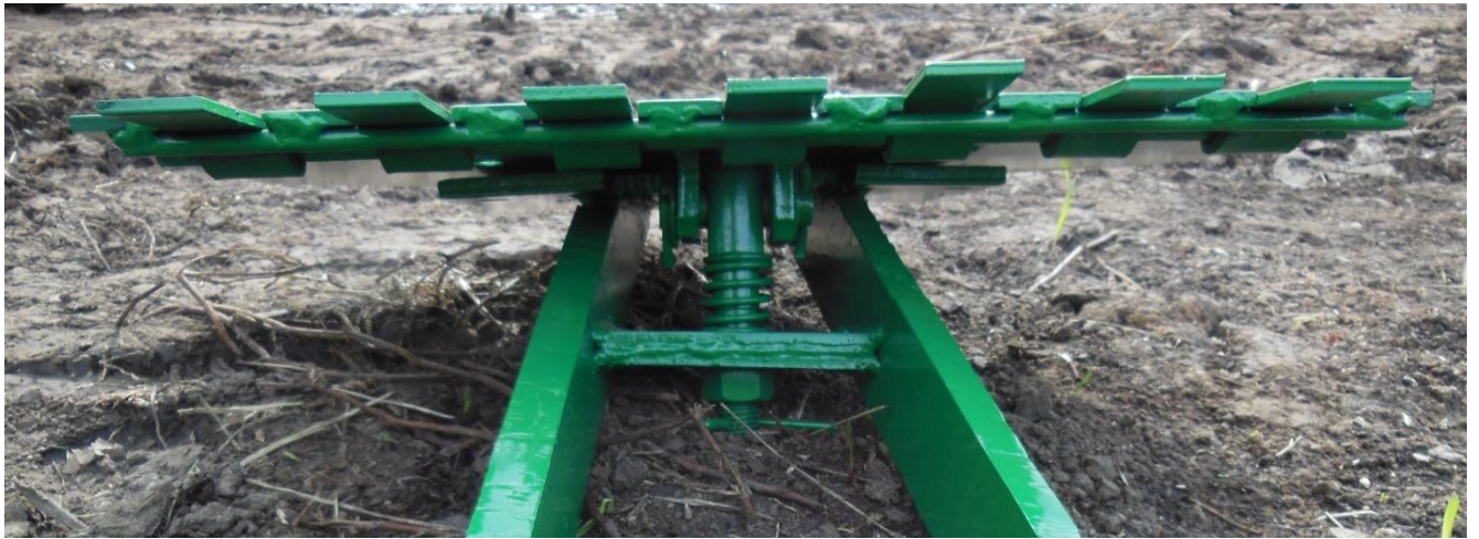
Рисунок 3.2 – Общий вид пружинного механизма усовершенствованного подкапывающего рабочего органа
