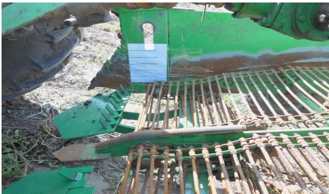
Рисунок 3.4 – Общий вид измерительной шкалы для фиксации высоты подскока компонентов
