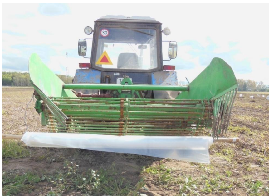
Рисунок 4.4 –Усовершенствованный картофелекопатель КТН-2В во время определения полноты уборки (вид сзади)
