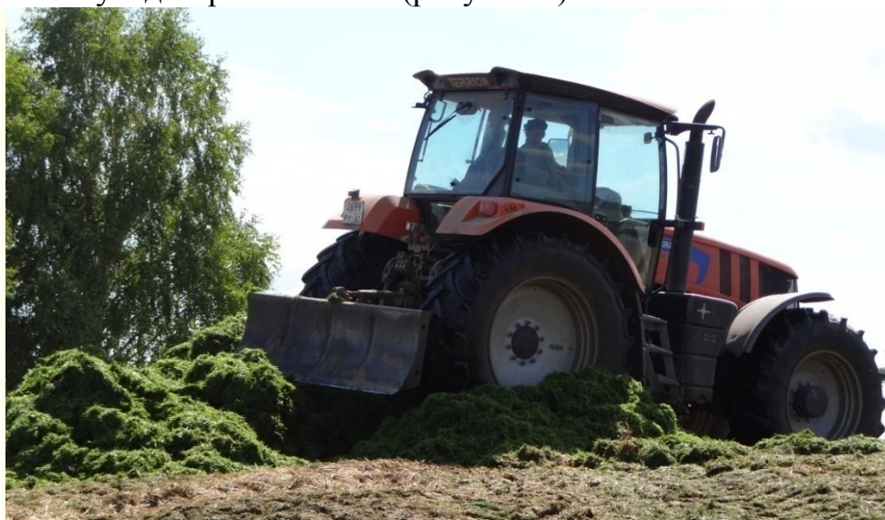
Рисунок 3 – Трактор TERRION АТМ 3180 с бульдозерным отвалом для распределения сенажной массы
