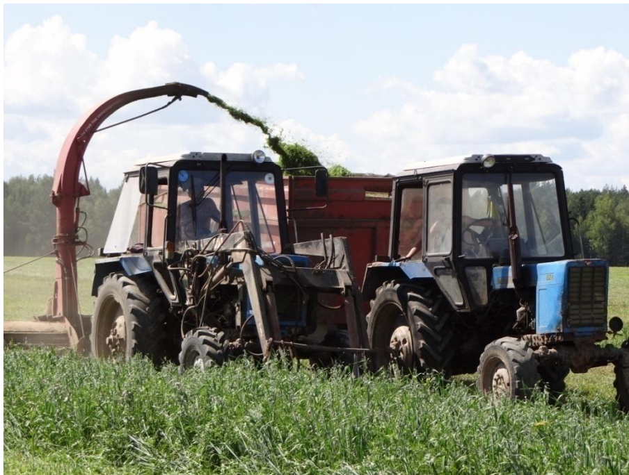
Рисунок 2 – Подбор, измельчение и погрузка массы прицепным кормоуборочным комбайном КУФ-1,8
