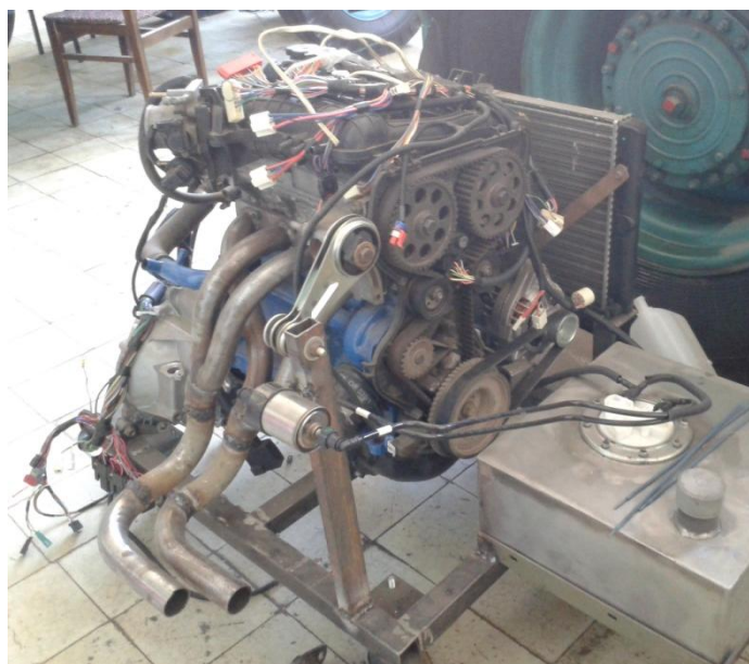
Рисунок 1 – Учебный стенд на базе двигателя VAZ-21124
