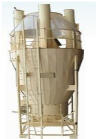
Рисунок 1 – Установка для сушки жома свеклы «Циклон».
