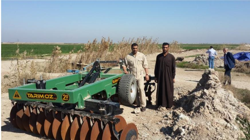
Рисунок 10 – Сельскохозяйственные машины для поверхностной обработки почвы применяемые на предприятии. Дисковая борона Tarimoz, пр-во Турция
