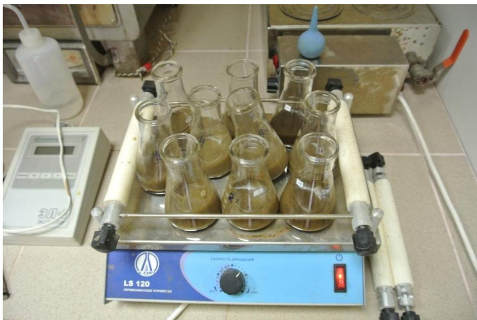
Рисунок 3 – Процесс экстрагирования нефтепродуктов из почвенных проб
