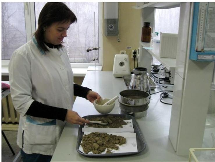
Рисунок 2 – Подготовка пробы почвы для лабораторного анализа
