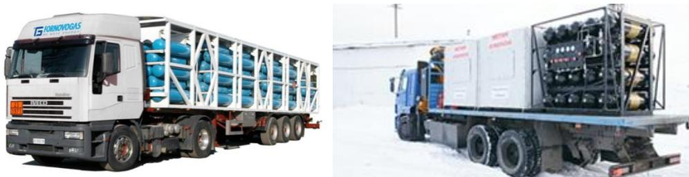
Рисунок 4 – Передвижные автомобильные газовые заправки (ПАГЗ)
