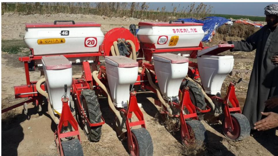
Рисунок 13 – Машины для посева и посадки сельскохозяйственных культур. Сеялка кукурузная четырехрядная Sakalak, пр-во Турция
