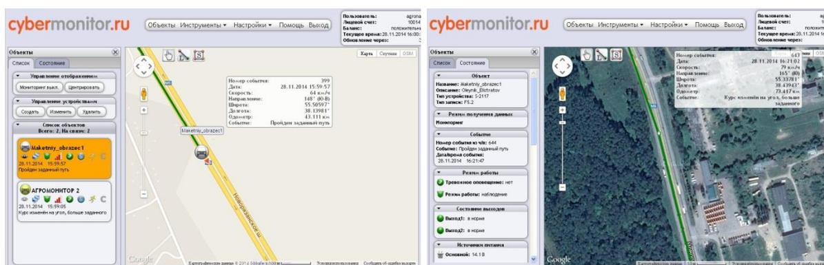
Рисунок 2 – Интерфейс пользователя (диспетчера) системы спутникового контроля и мониторинга
