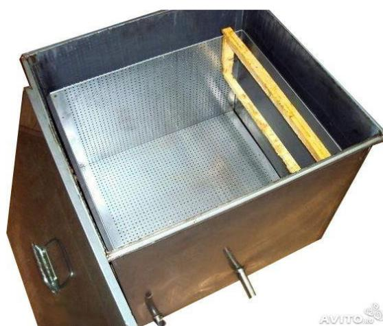
Рисунок 4 – Паровая рамочная воскотопка на 8 ульевых рамок
