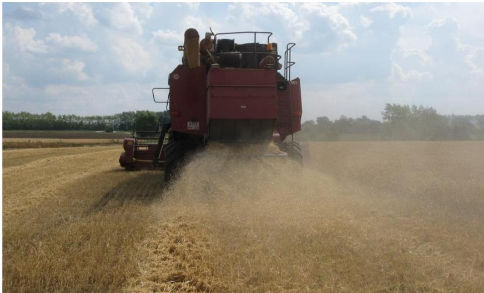
Рисунок 2 – Работа соломоизмельчителя зерноуборочного комбайна ПАЛЕССЕ GS12
