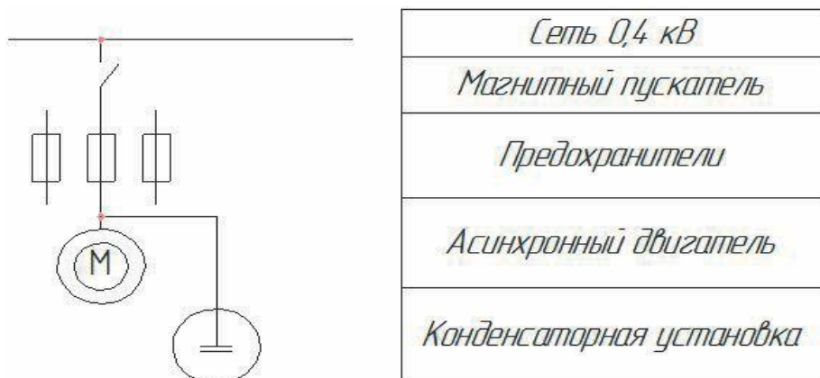
Рисунок 1 - Схема включения КУ при индивидуальной компенсации
