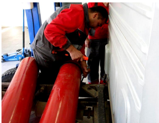
Рисунок 2 – Установка газовых баллонов в ООО «ЭкоГаз»
