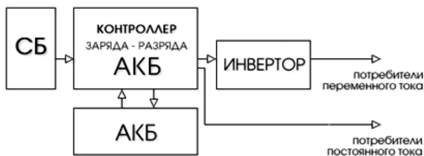
Рисунок 2 – Упрощенная блок-схема солнечной электростанции.
