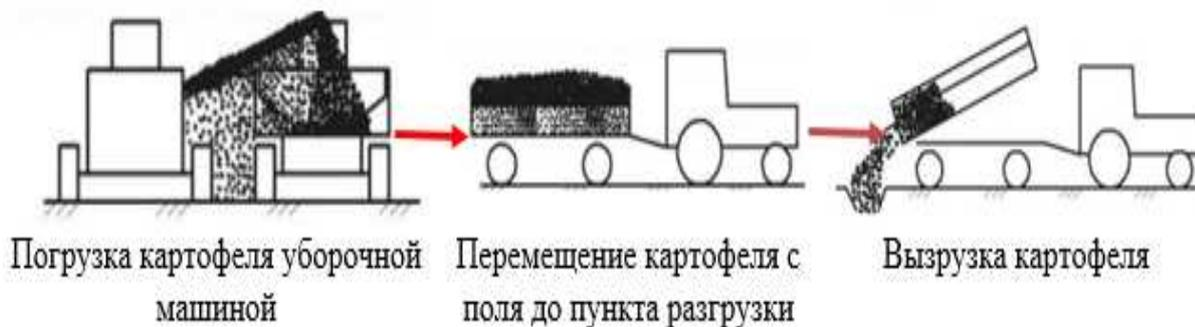
Рисунок 2 – Схема процесса транспортировки картофеля с поля
