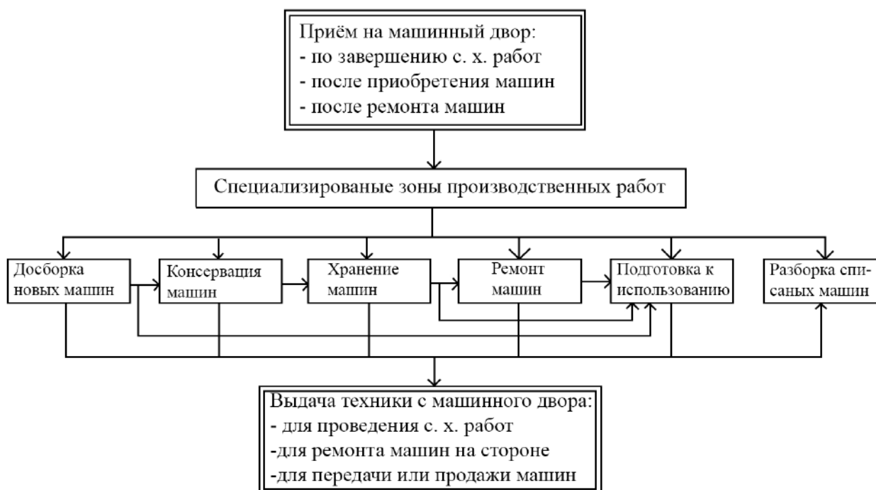
Рис. 4. Организационно-технологическая схема проведения работ на машинном дворе.
