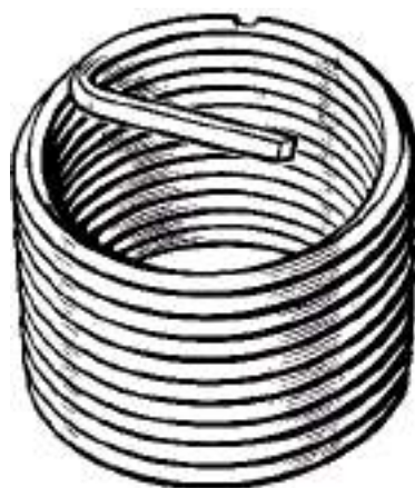
Рисунок 3 – Резьбовая спиральная вставка.
