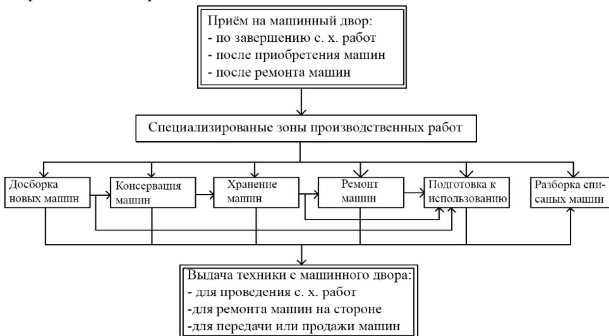
Рис. 4. Организационно-технологическая схема проведения работ на машинном дворе.
