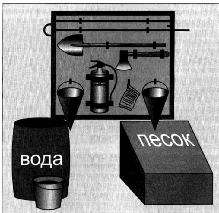
Рисунок 1. Пожарный щит первичных средств пожаротушения
