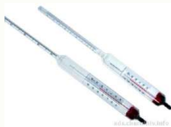
Рисунок 1. Ареометр и отсчет по его шкале
