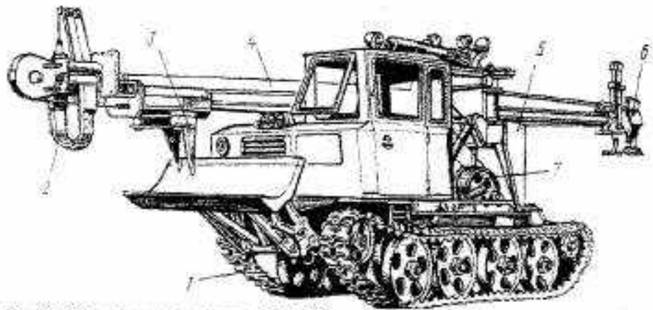
Рис. 62. Сучкорезная машина ЛП-30Г:
