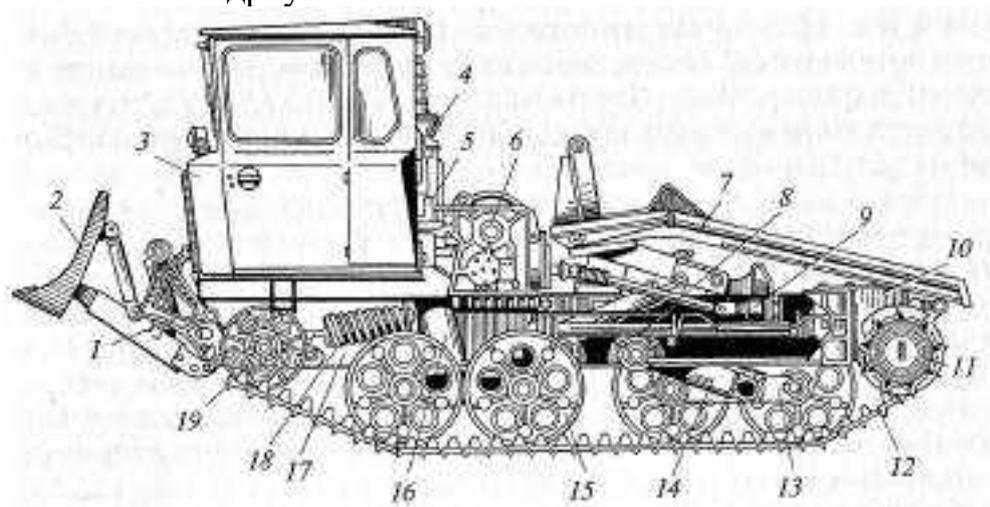
Рис. 2. Трелевочный трактор ТДТ-55А:
