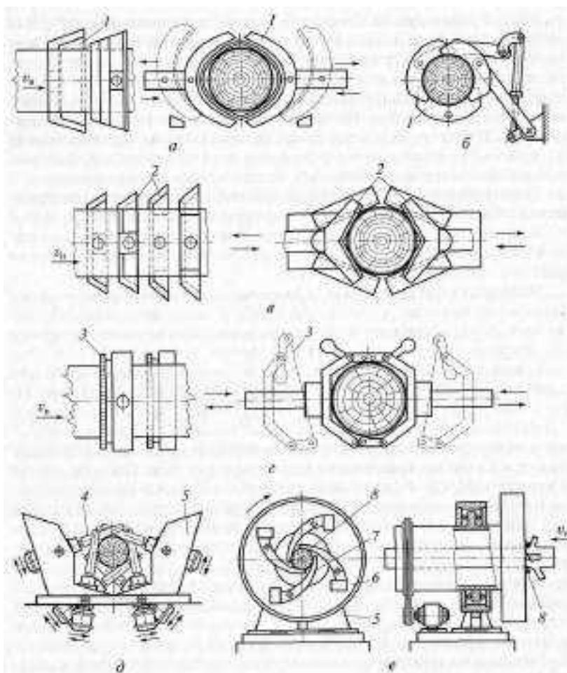
Рис. 1. Схемы механизмов резания сучкорезных машин и установок:
