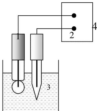
Рис.1.Схема установки для измерения pH раствора со стеклянным электродом: 1– индикаторный стеклянный электрод; 2– хлорсеребряный электрод сравнения 3– стакан с исследуемым раствором; 4– pH-метр
