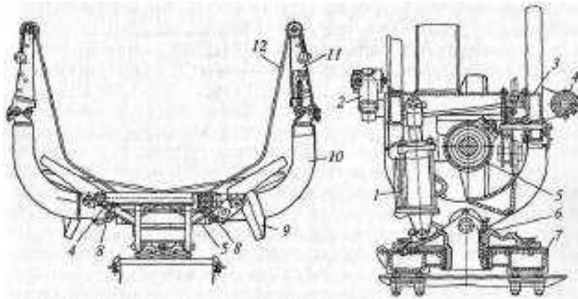
Рис. 6. Коник трактора ТБ-1М:
