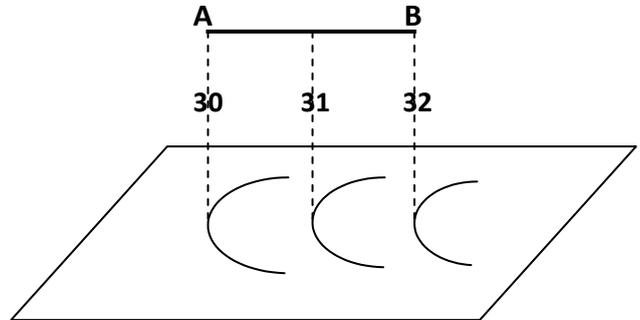
Горизонтали можно вычертить с помощью полетки следовательно, графически.
