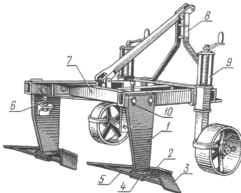
Рис. 4. Культиватор-плоскорез-глубококорыхлитель КПГ-250А:
