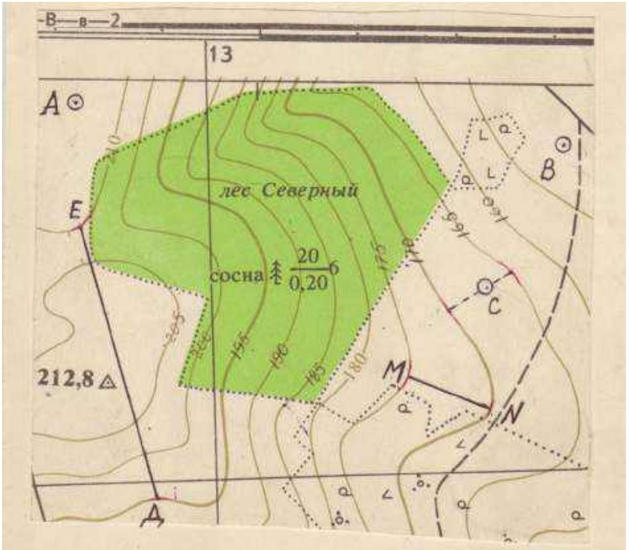
Высота сечения рельефа  $h=5\text{м}$
