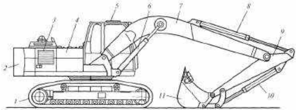
Рисунок 19. Одноковшовый полноповоротный гусеничный экскаватор ЕТ-18:
