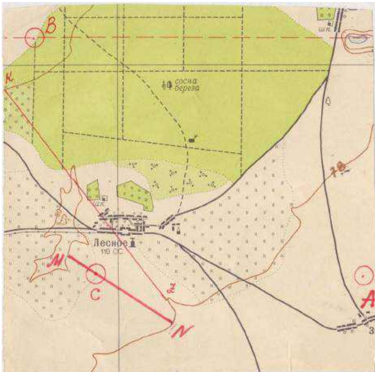
Высота сечения рельефа  $h=2\text{м}$
