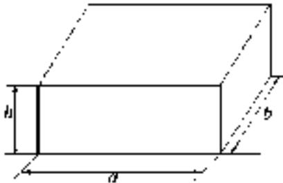
Длину  $a$  и ширину  $b$  тела измеряют штангенциркулем, высоту  $h$  – микрометром. Массу определяем взвешиванием.
