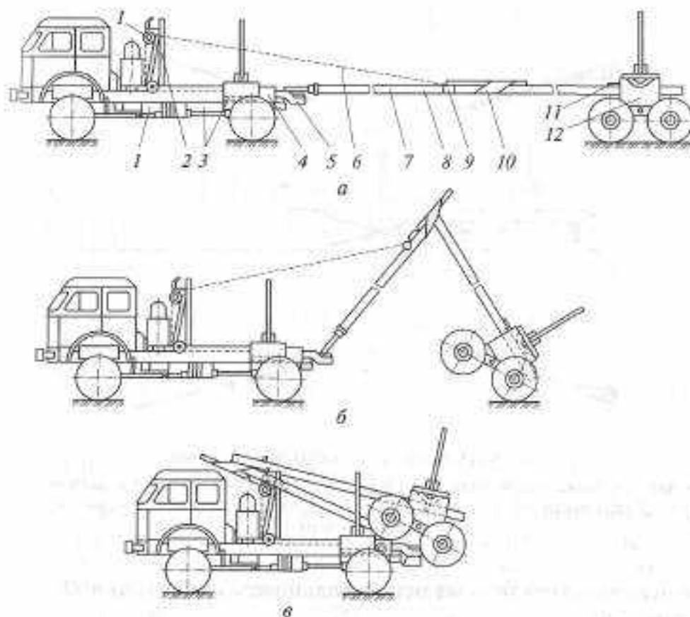
Рис. 4.2. Схема погрузки роспуска на шасси автомобиля:
