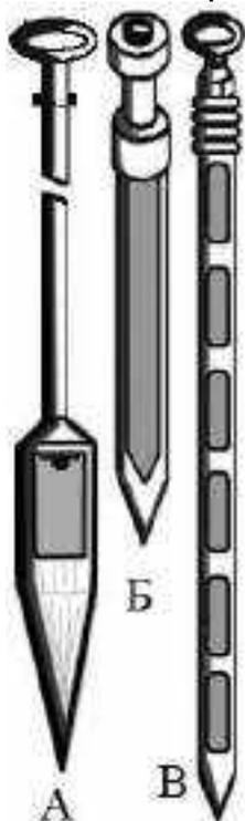
Рисунок 11 - Щупы: а - конусный; б - мешочный; в – цилиндрический
