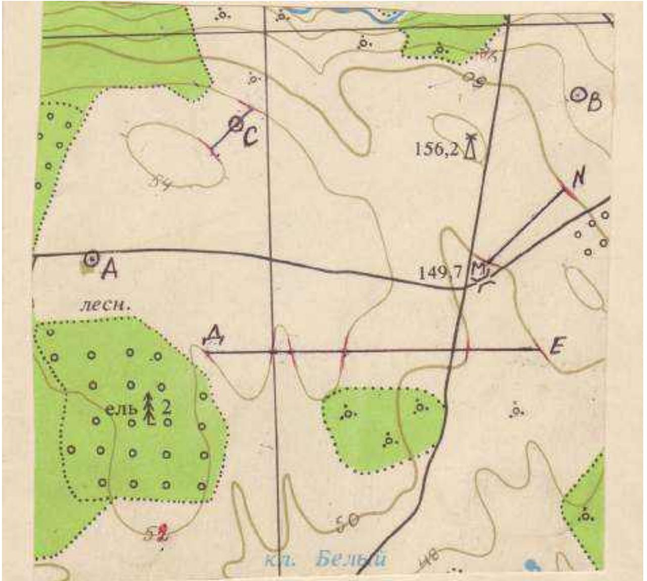
Высота сечения рельефа  $h=2\text{м}$
