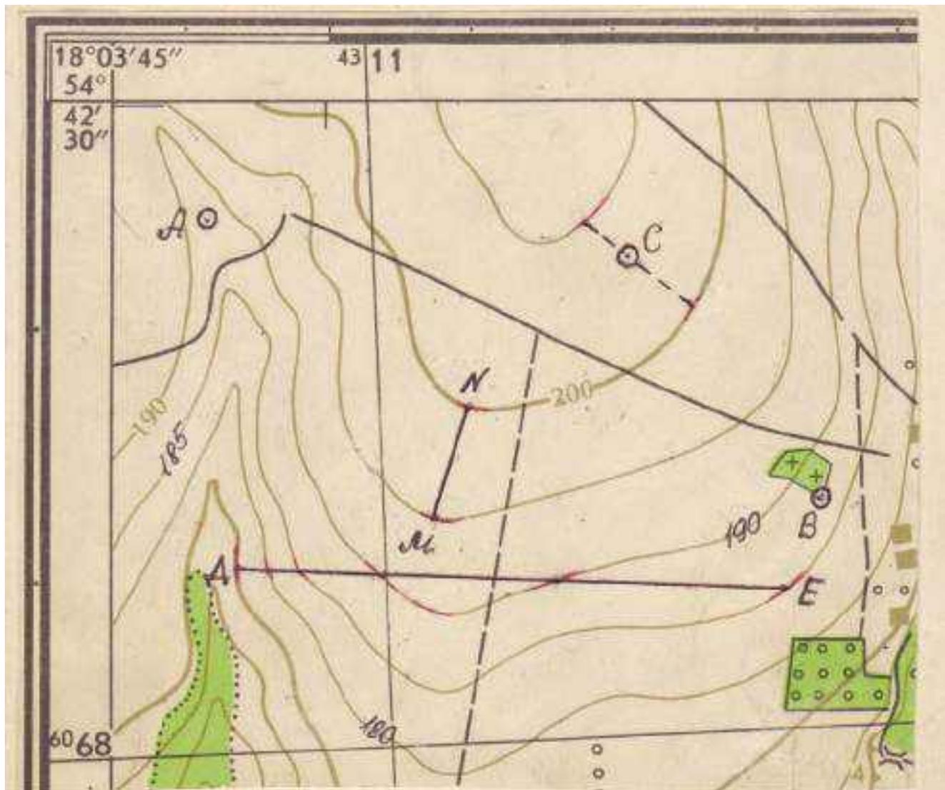
Высота сечения рельефа  $h=5\text{м}$
