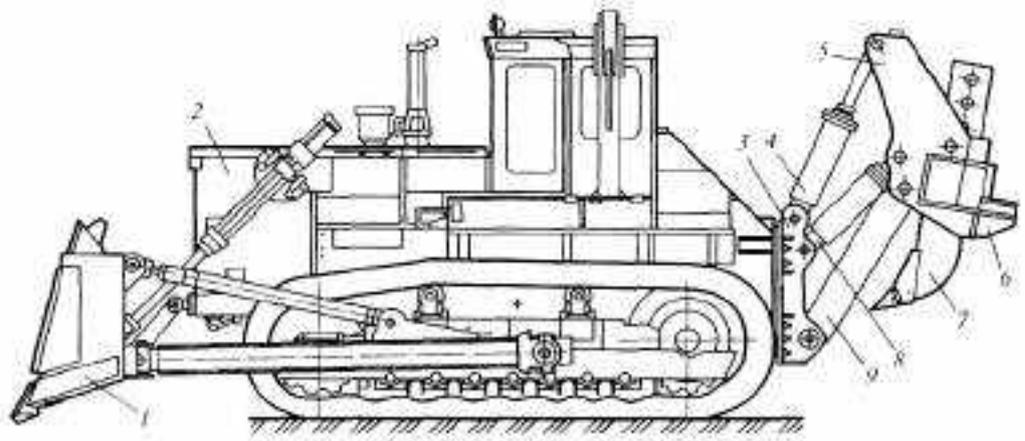
Рис. 4.13. Бульдозер-рыхлитель на базе трактора Т-35.01
