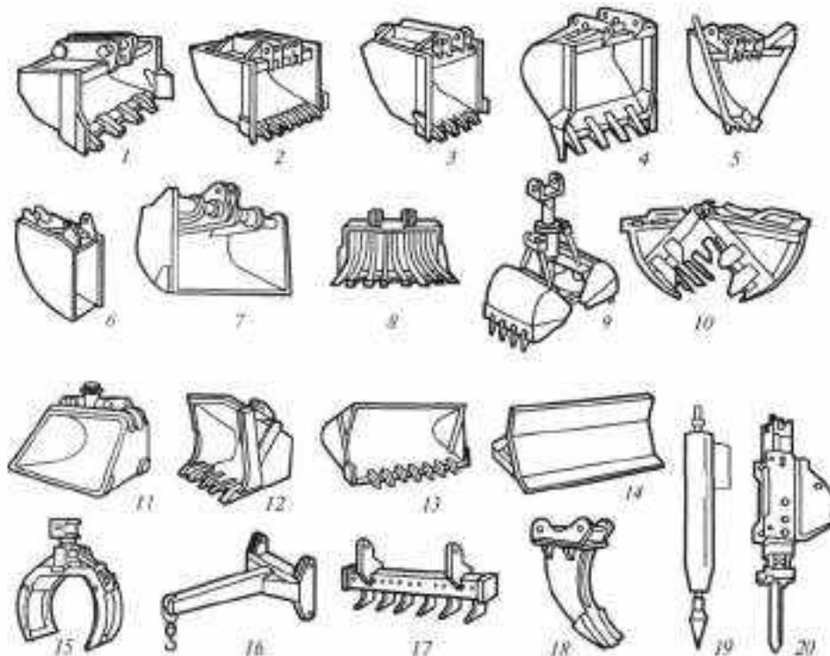
Рисунок 8. Сменные рабочие органы гидравлических экскаваторов
