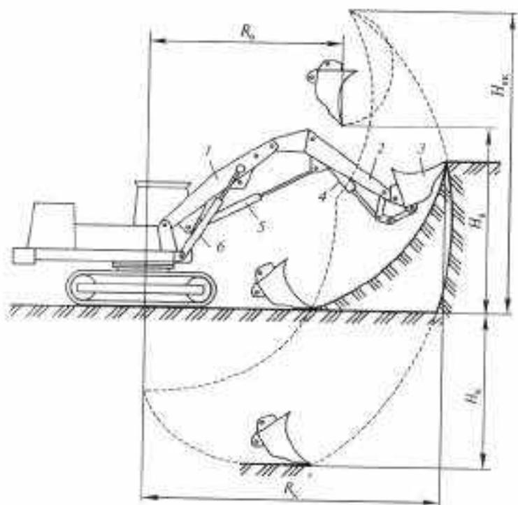
Рисунок 10. Экскаватор с рабочим оборудованием прямая лопата
