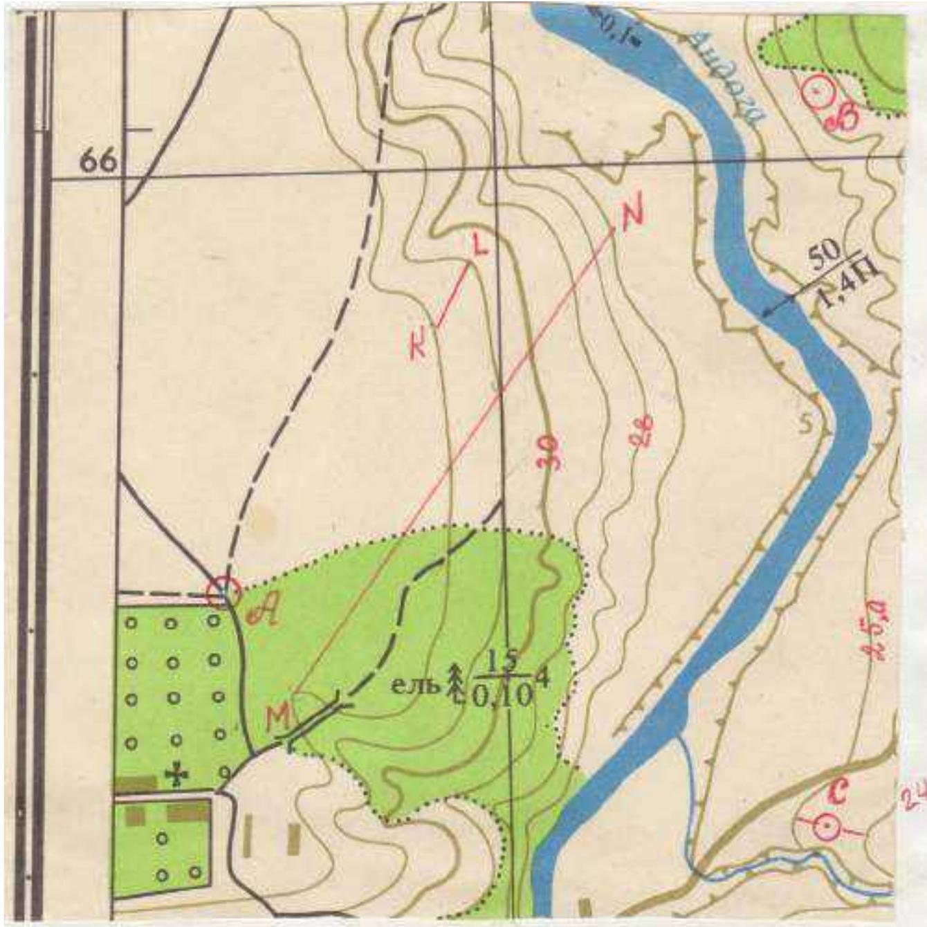
Высота сечения рельефа  $h=1\text{м}$
