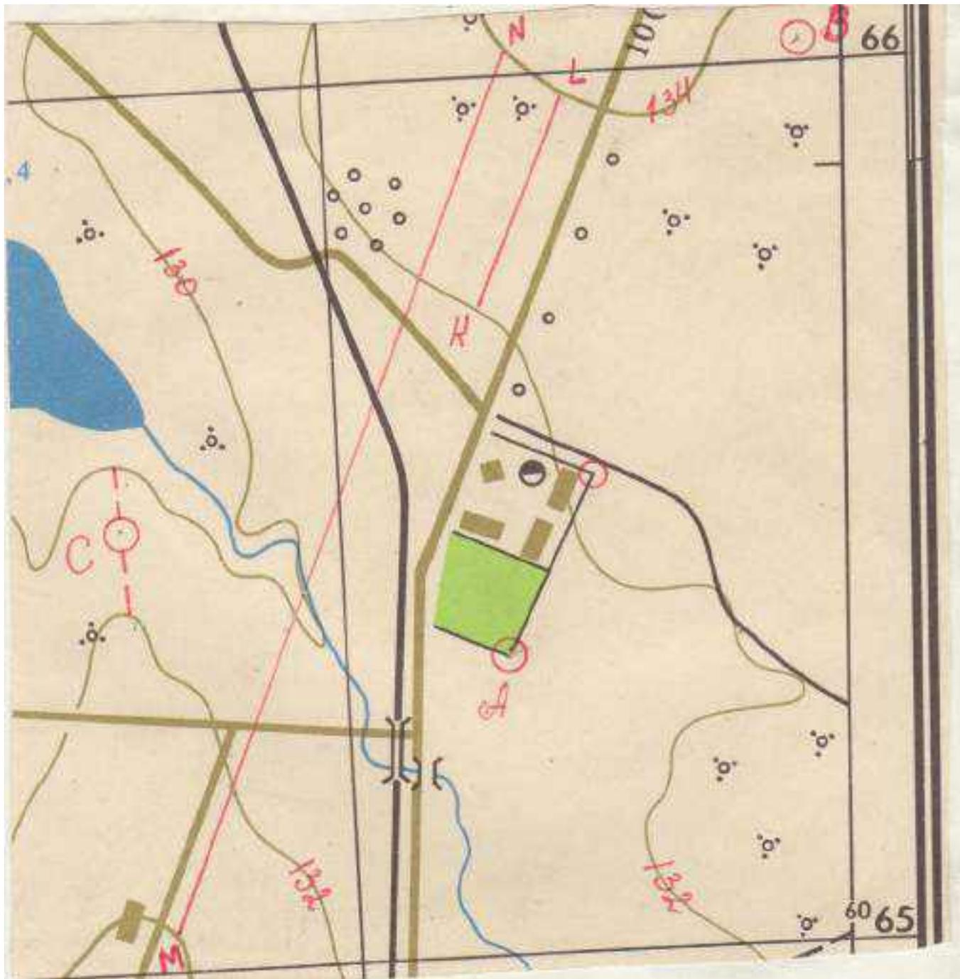
Высота сечения рельефа  $h=2\text{м}$
