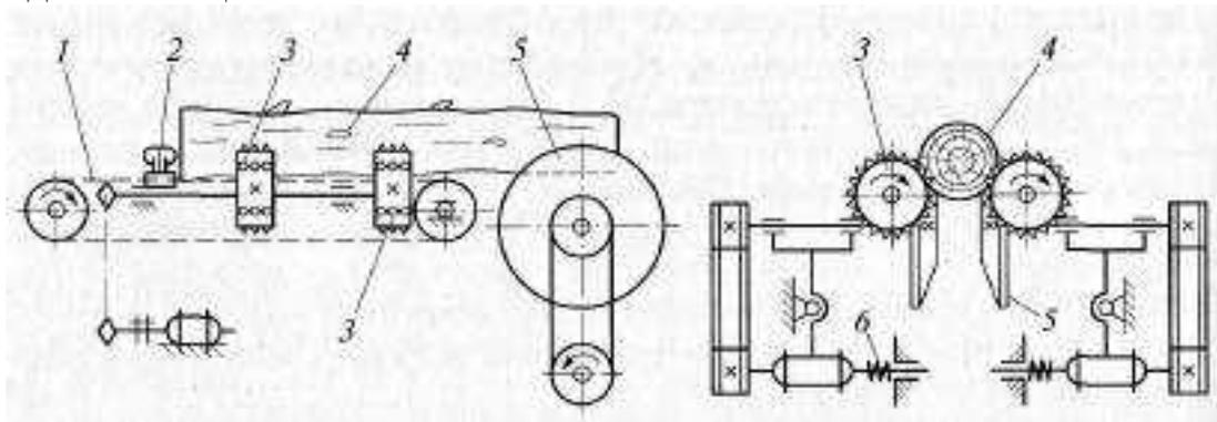
Рис. 9. Винтовой фрезерный окорочный станок:
