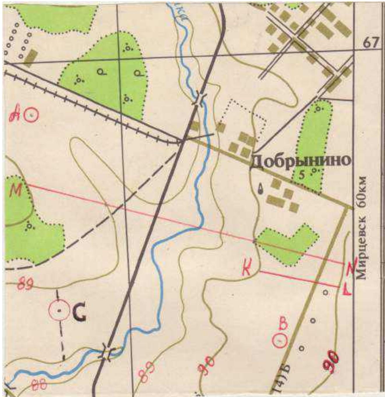
Высота сечения рельефа  $h=1\text{м}$
