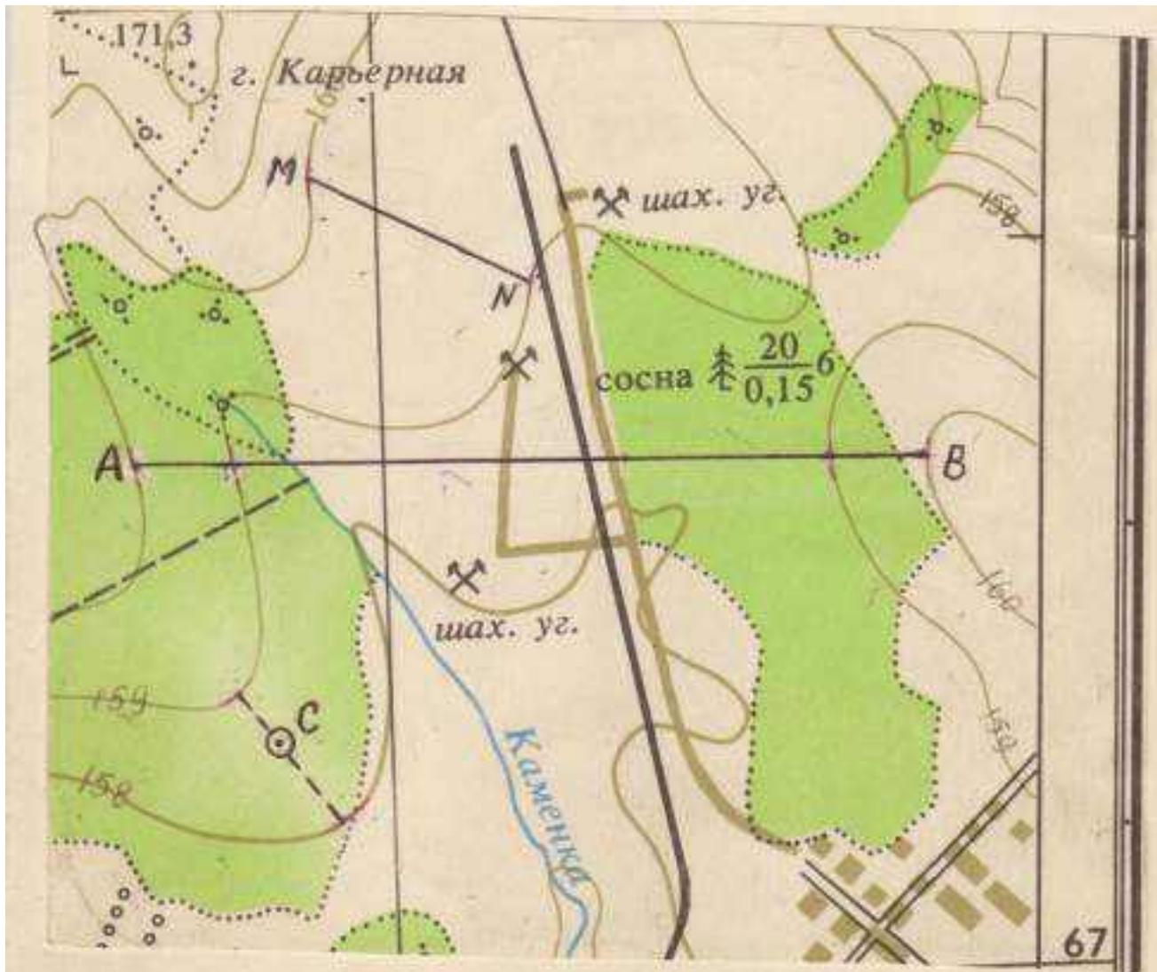
Высота сечения рельефа  $h=1\text{м}$
