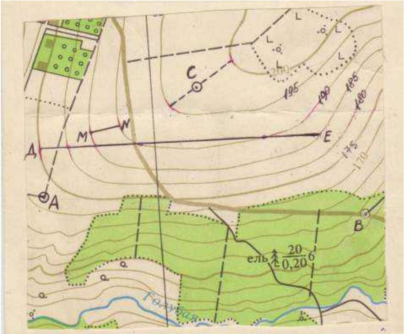
Высота сечения рельефа  $h=5\text{м}$
