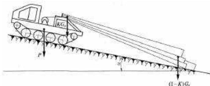
Рис. 1. Схема для расчета рейсовой нагрузки трелевочного трактора
