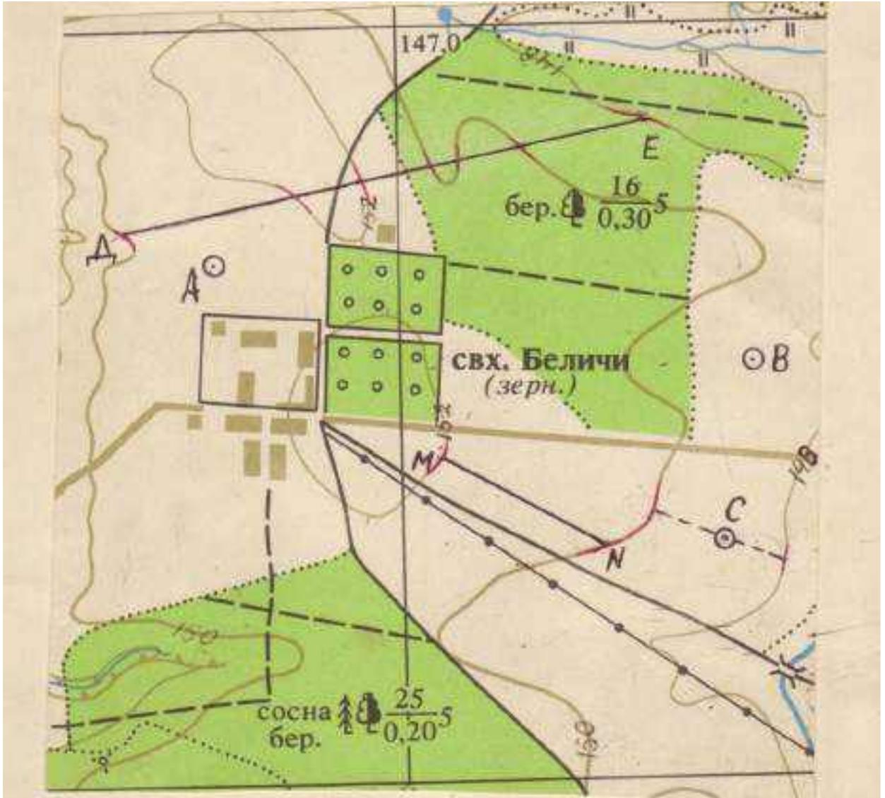
Высота сечения рельефа  $h=2\text{м}$
