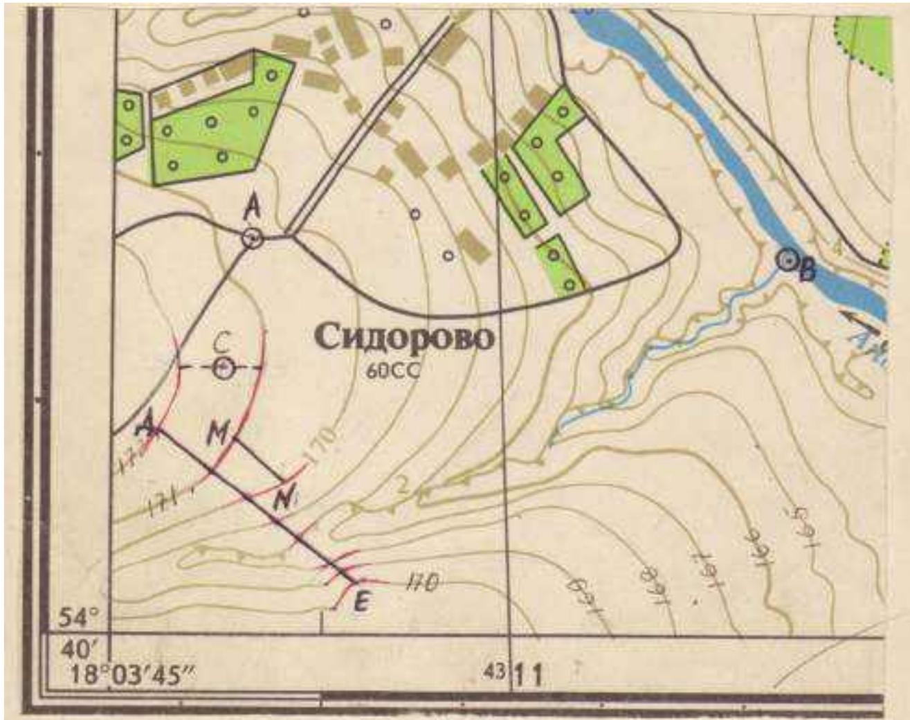
Высота сечения рельефа  $h=1\text{м}$
