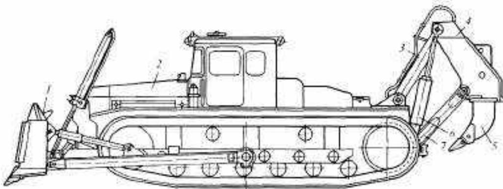
Рис. 4.11. Бульдозер-рыхлитель ДЭТ-250М2Б1Р1
