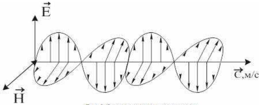
Рис.1 Электромагнитная волна
