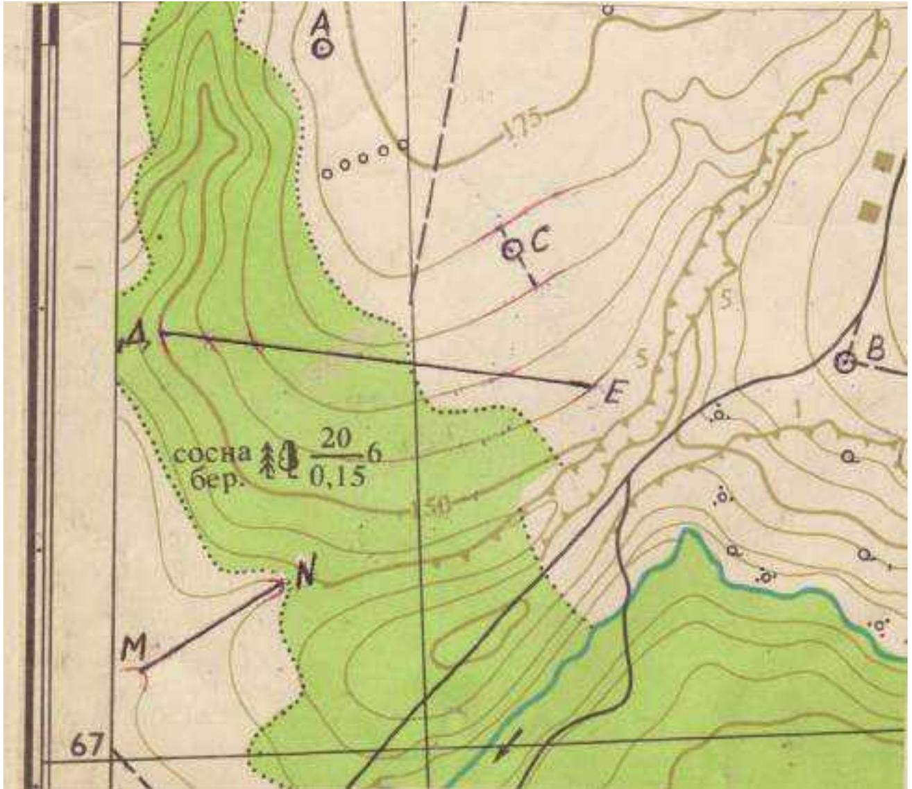
Высота сечения рельефа  $h=5\text{м}$
