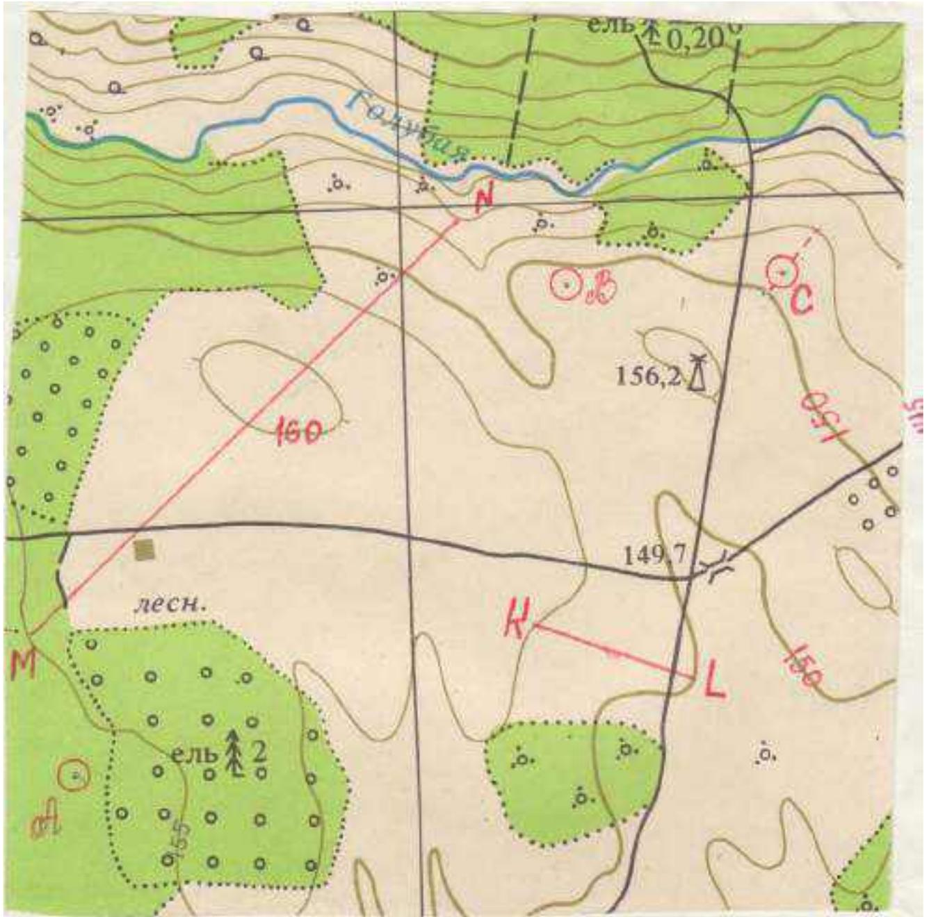
Высота сечения рельефа  $h=5\text{м}$
