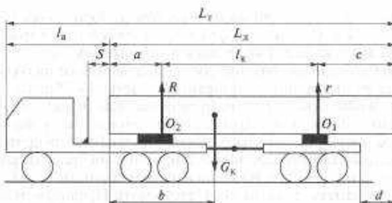
Рис. 4.4. Схема автопоезда к расчету расстояния между кониками:
