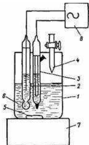
Рис. 3. Схема электрохимической ячейки для потенциометрического титрования
