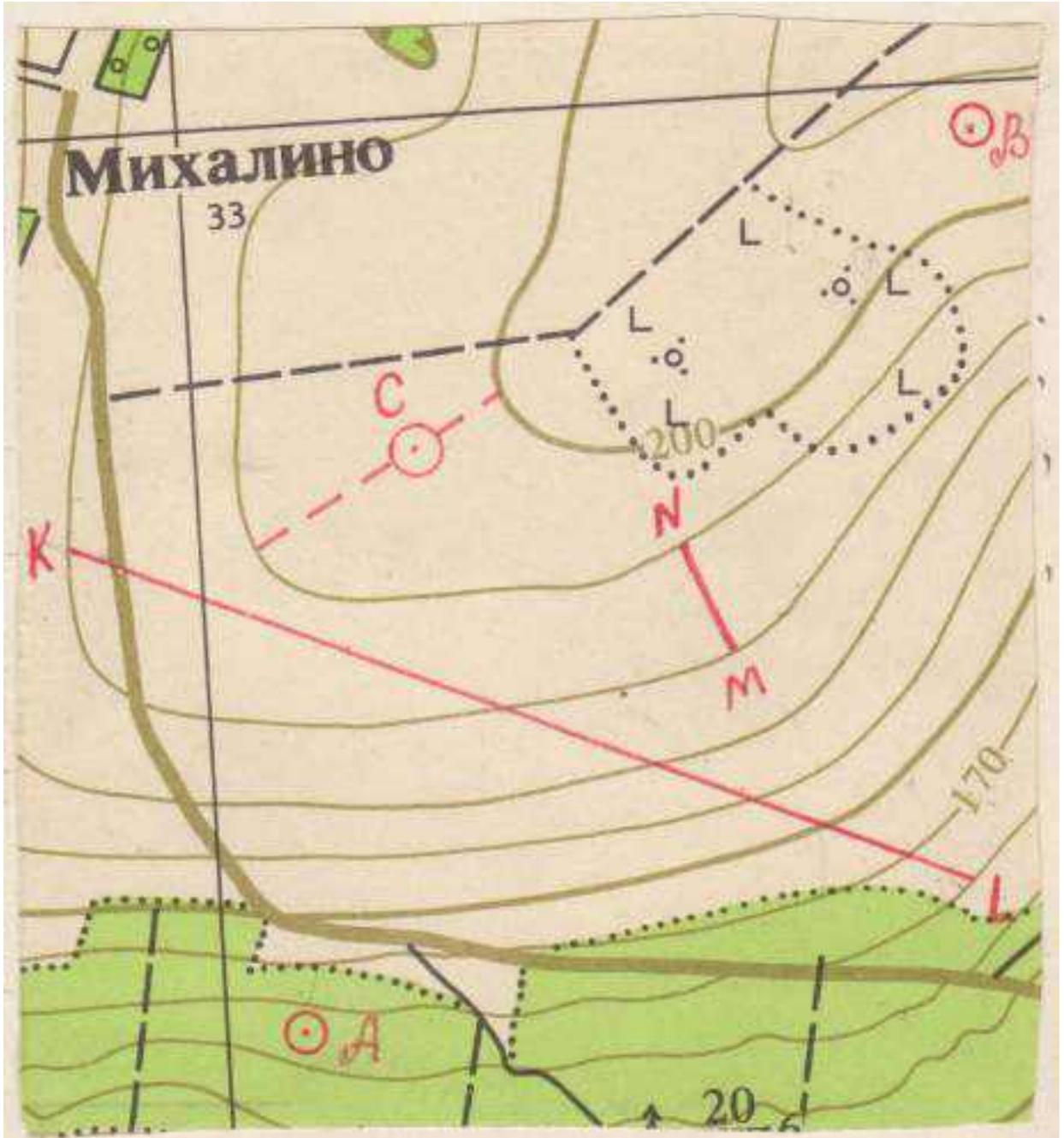
Высота сечения рельефа  $h=5\text{м}$
