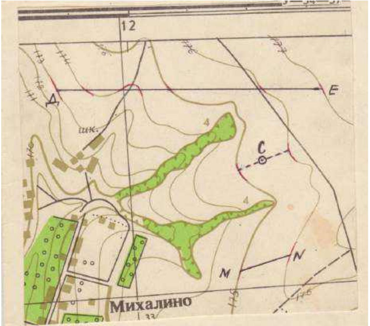
Высота сечения рельефа  $h=1\text{ м}$
