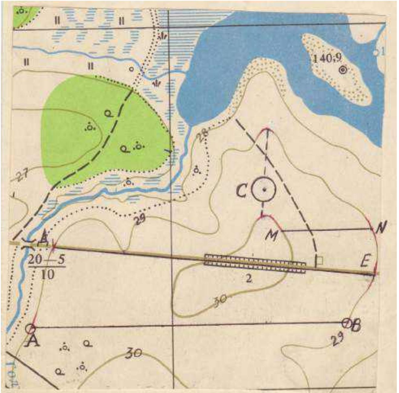
Высота сечения рельефа  $h=1\text{м}$
