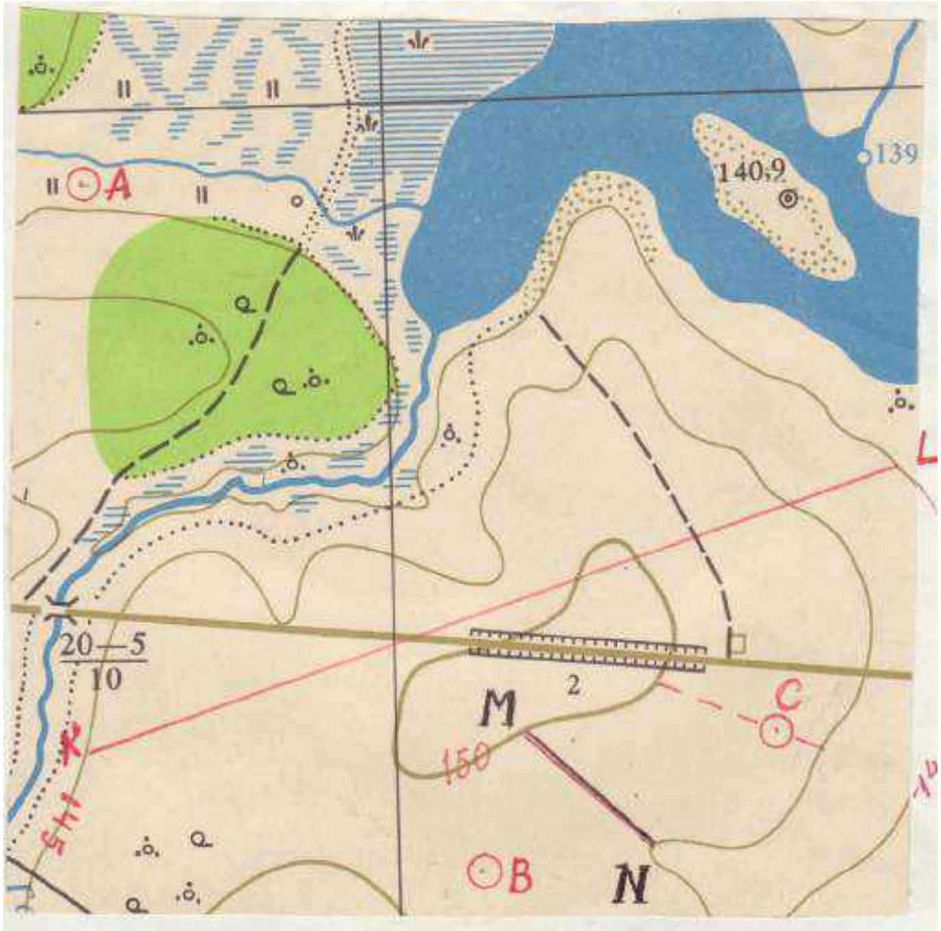
Высота сечения рельефа  $h=5\text{м}$
