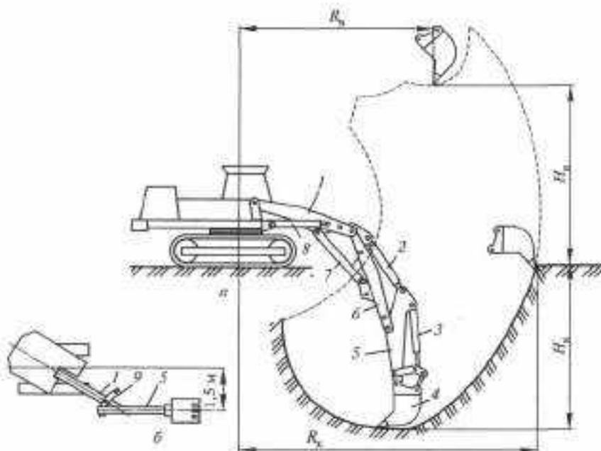
Рисунок 9 . Экскаватор с рабочим оборудованием обратная лопата
