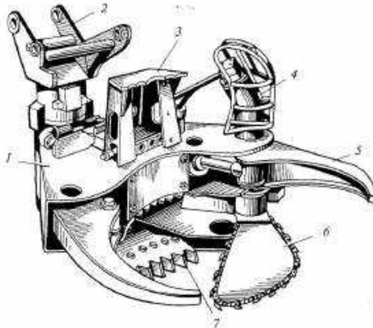
Рис. 3.8. Захватно-срезающее валочное устройство машины ЛП-17:
