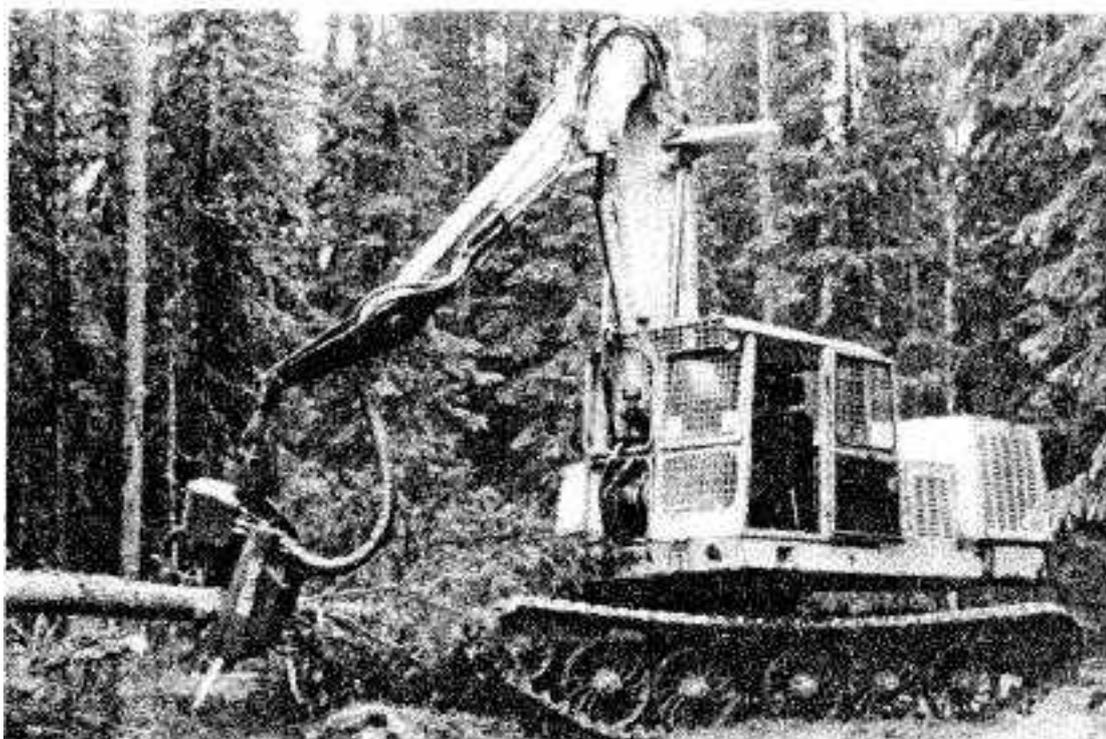
Рис. 2.37. Валочно-сучкорезно-раскряжевочная машина (харвестер) с сучкорезной головкой КЕТО-150
