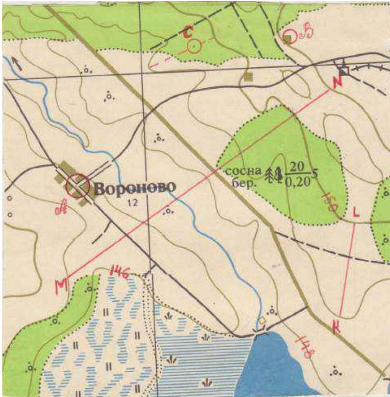
Высота сечения рельефа  $h=1\text{м}$
