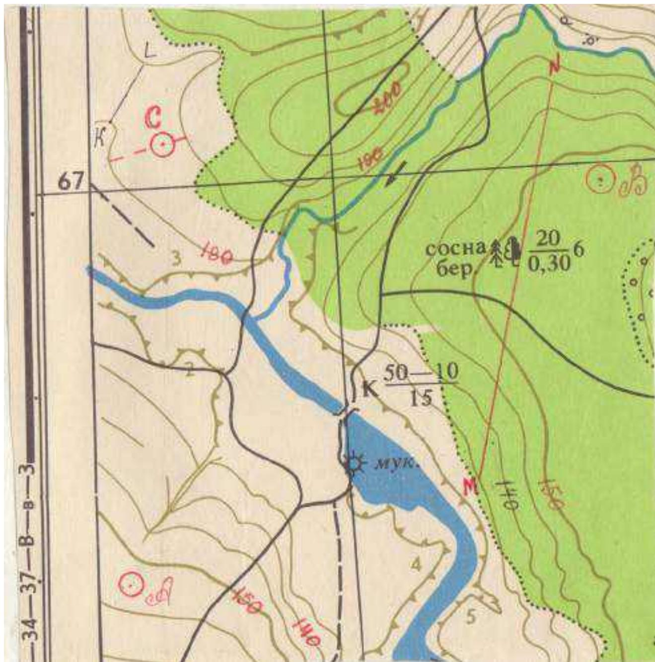
Высота сечения рельефа  $h=5\text{м}$
