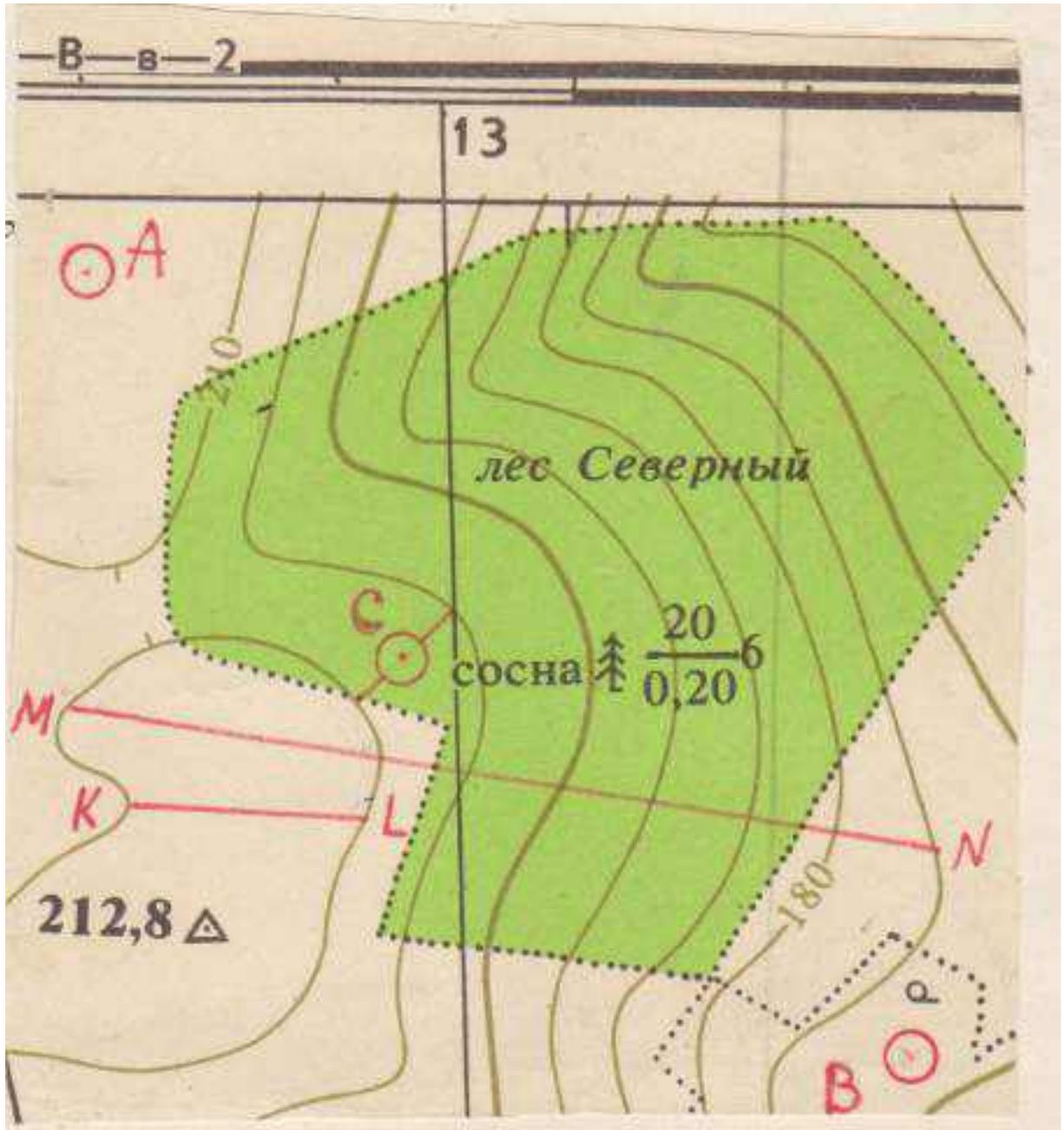
Высота сечения рельефа  $h=5\text{м}$
