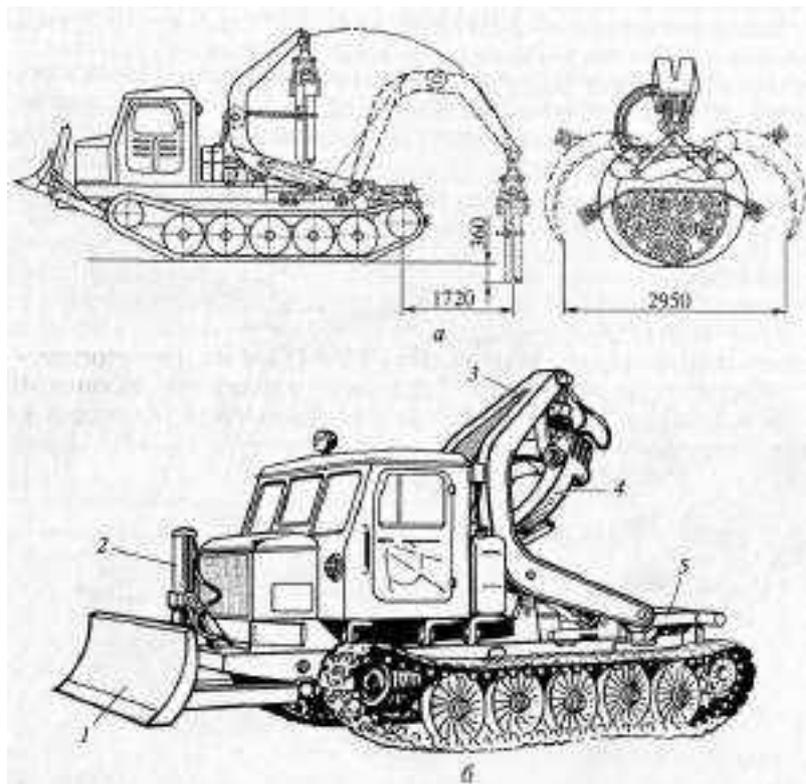
Рис. 7. Технологическое оборудование трактора ЛТ-154:
