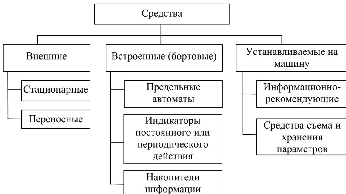
Рис. 4.7. Классификация средств технического диагностирования
