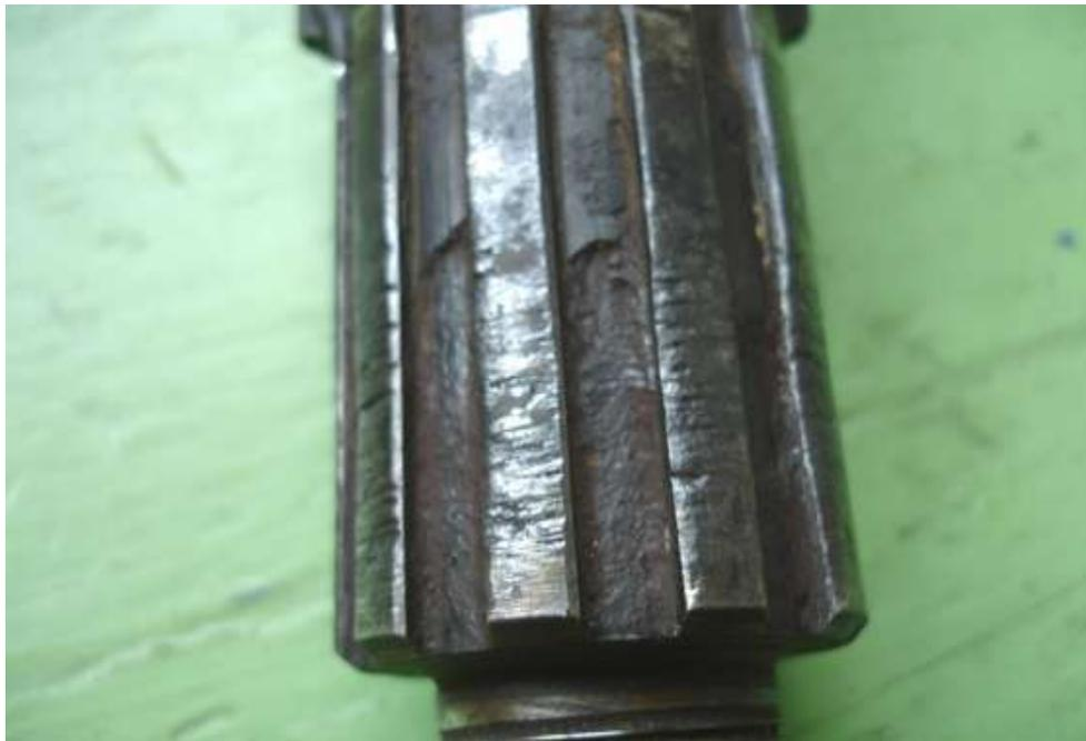
Рисунок 1.15 – Детали, подвергшиеся фреттинг – коррозии (шлицы вала).
