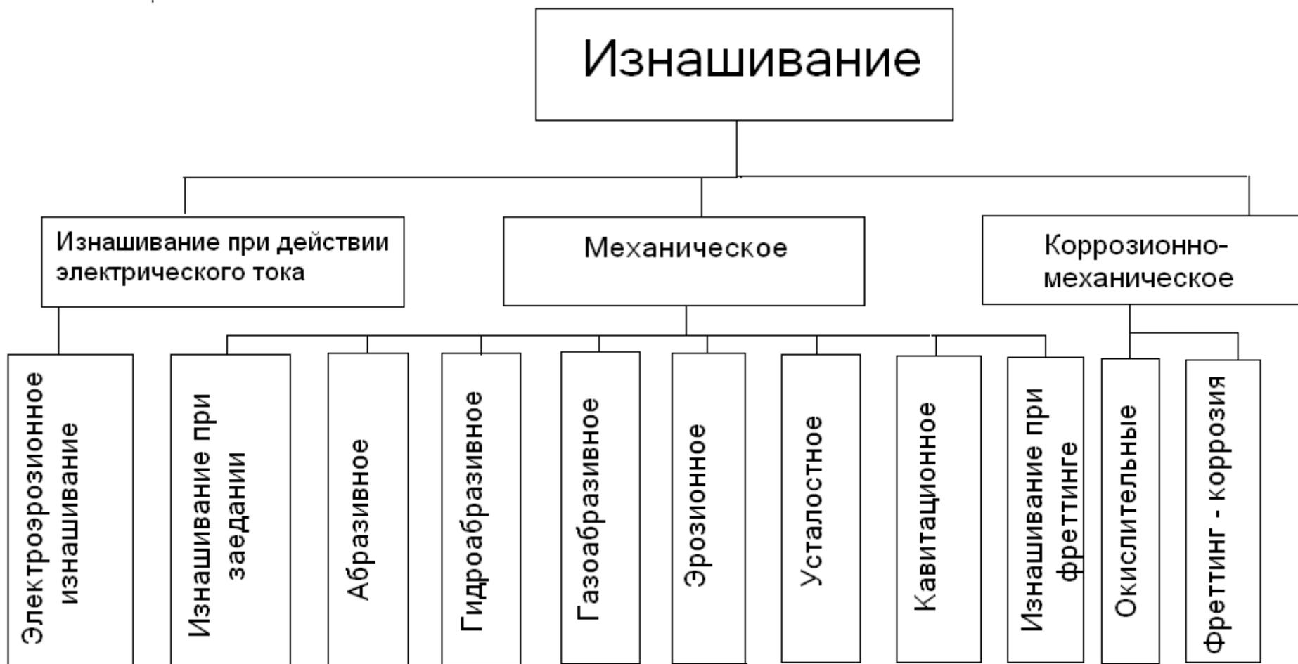
Рисунок 1.1 – Виды изнашивания деталей машин.
