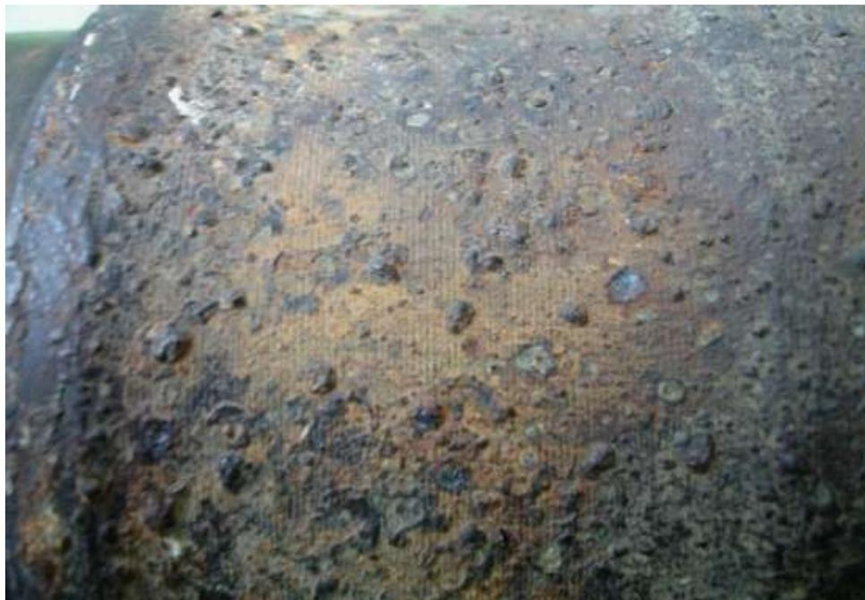
Рисунок 1.13 – Детали, подвергшиеся кавитационному износу (гильза цилиндра).
