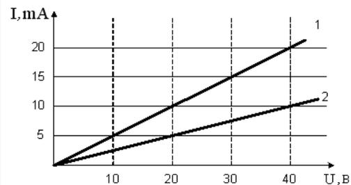
Отношение сопротивлений этих элементов  $R_1/R_2$  равно ...
