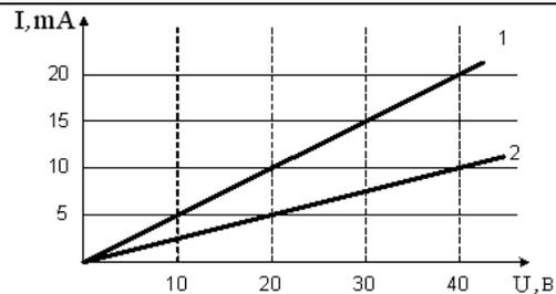
Отношение сопротивлений этих элементов  $R_1/R_2$  равно ...
