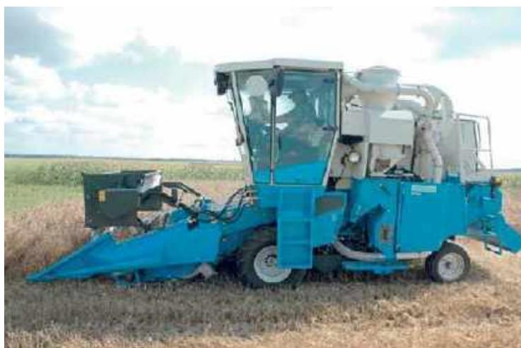
Рисунок 4- Селекционный зерноуборочный комбайн«Delta» Wintersteigen-ВИМ
