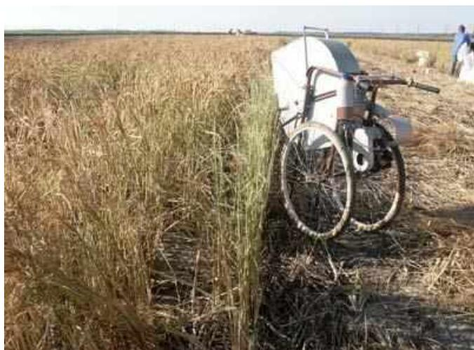
Рисунок 1- Селекционная однорядная зерноуборочная машина
