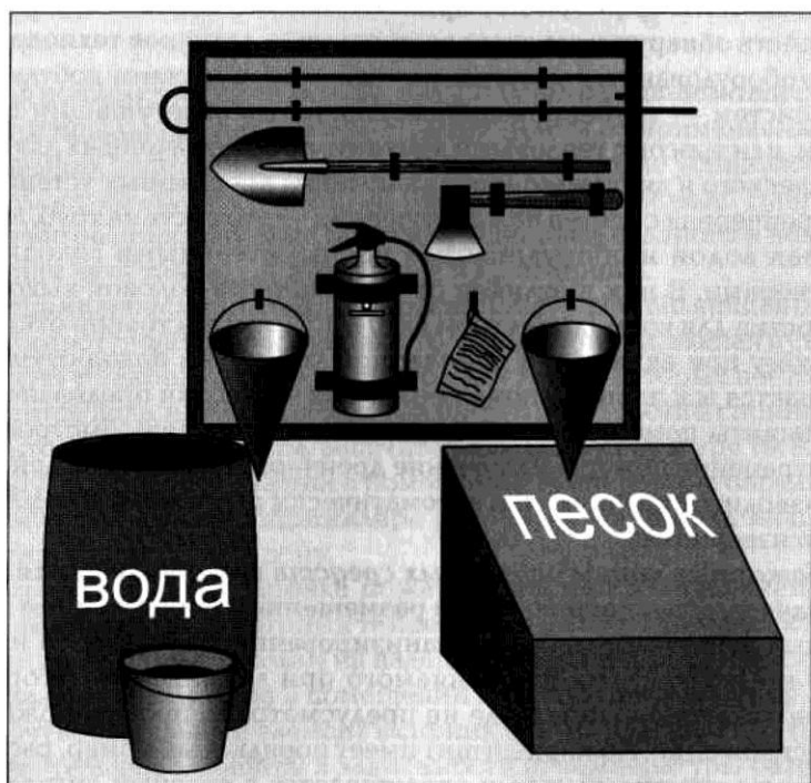
Рисунок 1. Пожарный щит первичных средств пожаротушения
