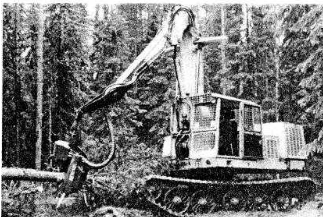
Рис. 2.37. Валочно-сучкорезно-раскряжевочная машина (харвестер) с сучкорезной головкой КЕТО-150
