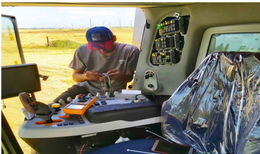
Рисунок 2 – Монтаж устройства информационной системы
