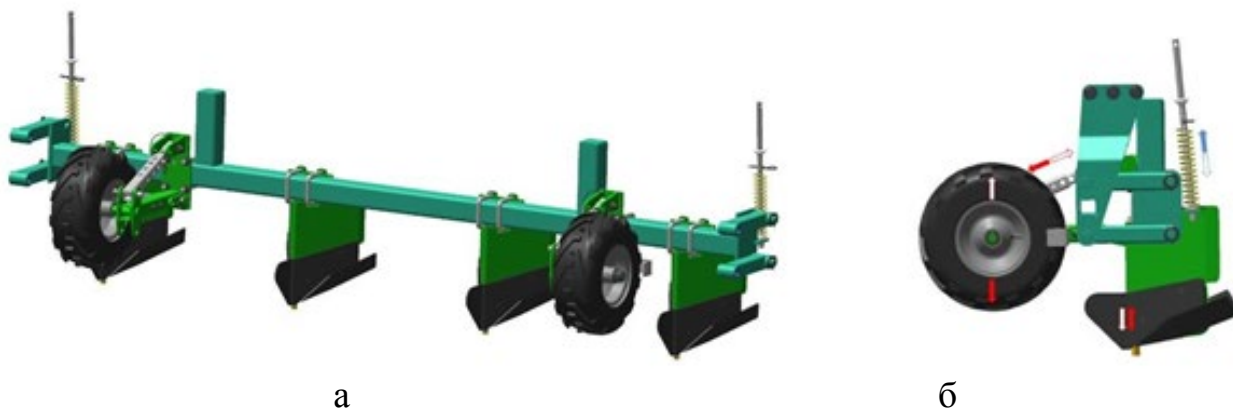
Рисунок 5 – Крепление сошников балке
