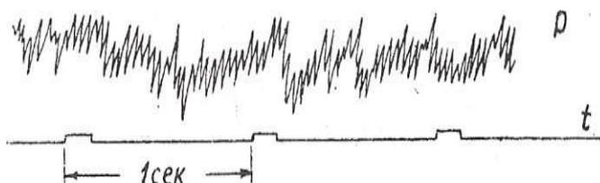
Рисунок 5 – Вибрационная составляющая тягового усилия на траках тягача М-2М (с МТ)
