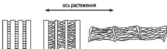
Рисунок 2 – Схема, иллюстрирующая коллапс структуры полимера, происходящий при больших значениях деформации в адсорбционно-активной жидкости, на различных стадиях растяжения
