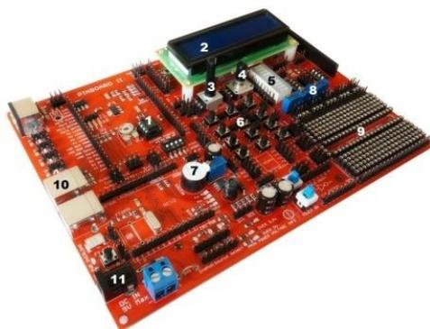
Рисунок 1 – Отладочная плата Pinboard 2
