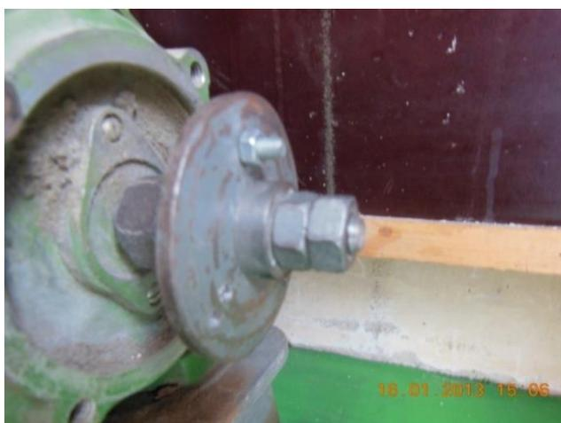
Рисунок 6 – Крепление груза массой 4 грамма в качестве эксцентрика
