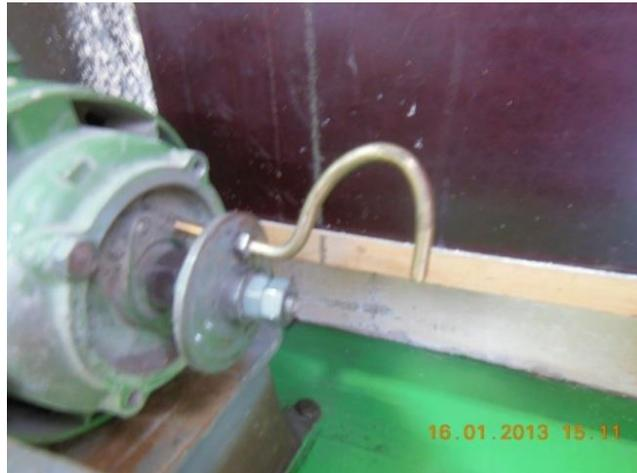
Рисунок 7 – Крепление груза массой 39 грамм в качестве эксцентрика
