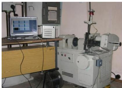
Рисунок 1 – Триботехнический комплекс для исследований процессов трения подвижных сопряжений
