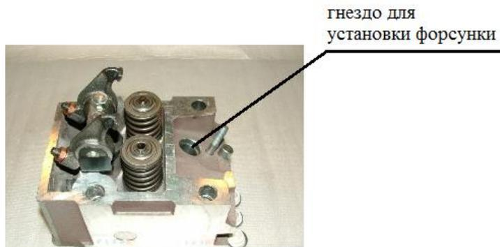
Рисунок 3- Место установки форсунки в головке блока, со стороны крышки головки блока цилиндров двигателя КамАЗ-740.30-260
