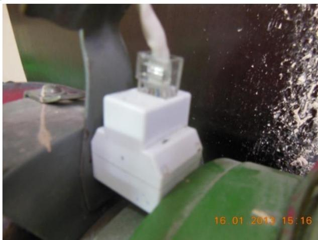
Рисунок 5 – Крепление датчика на установке
