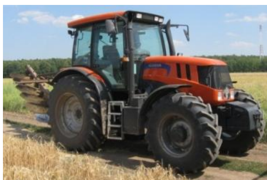
Рисунок 1 – Опытный пахотный агрегат АТМ 3180 «Terrion» + ПЛН-5-35
