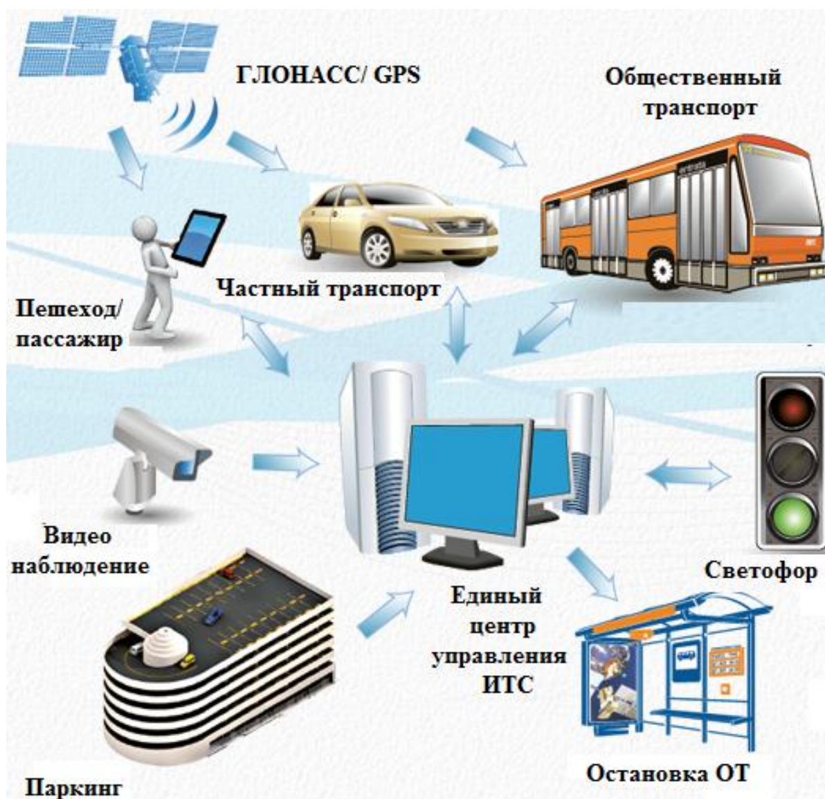
Рисунок – Схема информационных потоков в интеллектуальной системе управления транспортом
