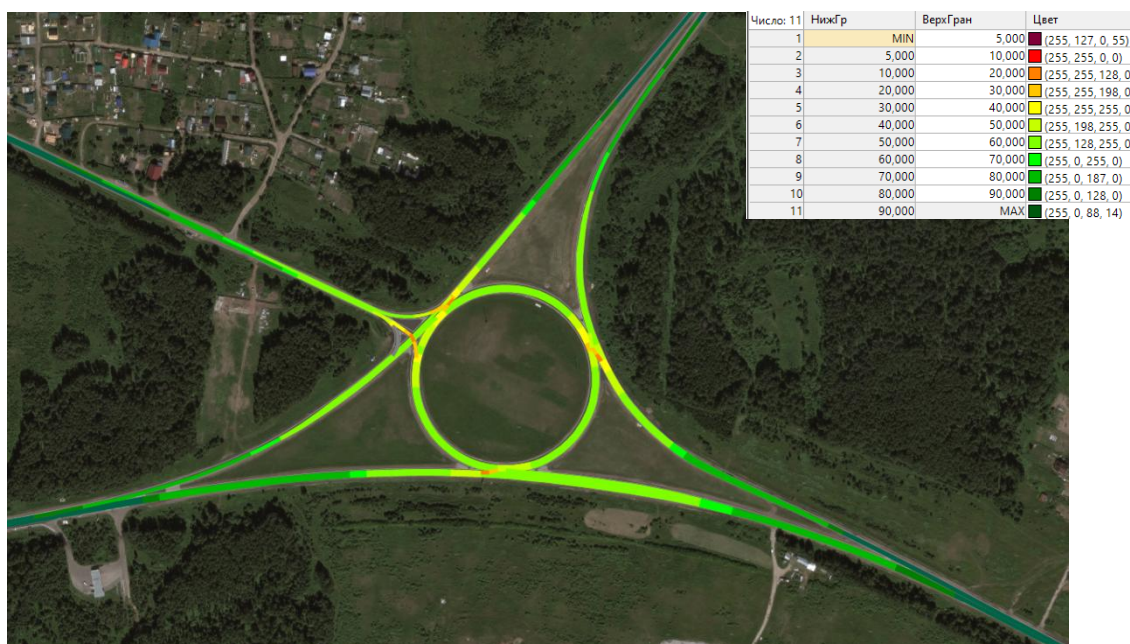
Рисунок 4 – Распределение скоростей движения ТС в узле № 1
