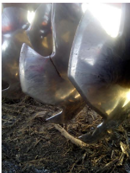
Рисунок 4 – Износ рабочих органов почвообрабатывающих машин
