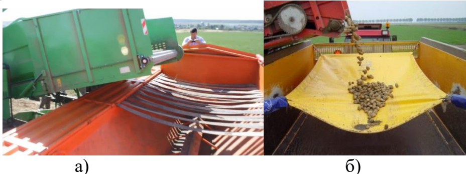
Рисунок 2 – Устройства для гашения энергии падения клубней: а – ременные, б – тентовый
