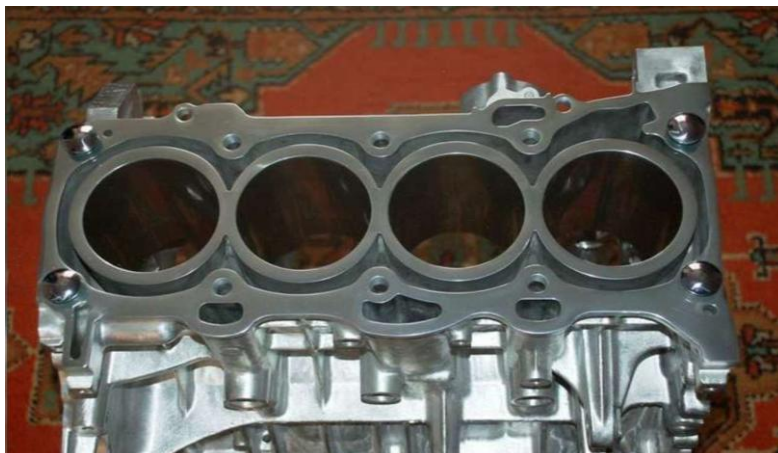
Рисунок 2 – Алюминиевый блок двигателя автомобиля с открытой водяной рубашкой
