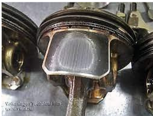
Рисунок 2 – Тепловой задир на юбке поршня
