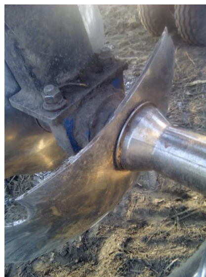
Рисунок 4 – Износ рабочих органов почвообрабатывающих машин
