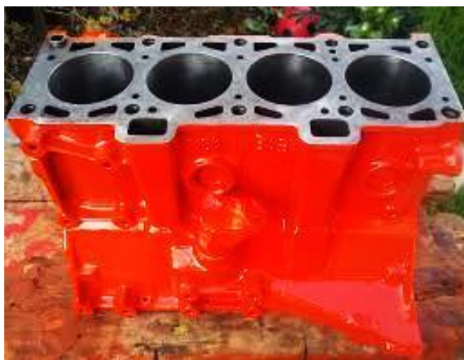
Рисунок 1 – Чугунный блок двигателя автомобиля с закрытой водяной рубашкой
