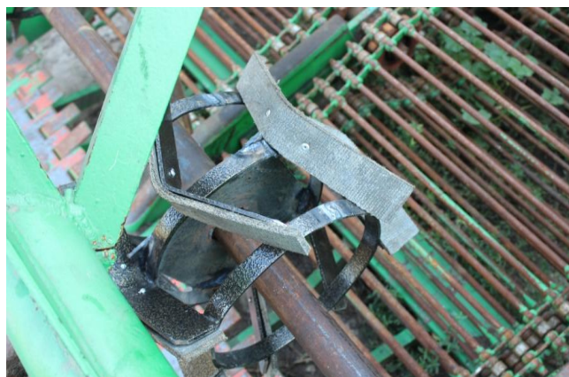
Рисунок 2 – Рыхлитель клубеносного пласта [8]
