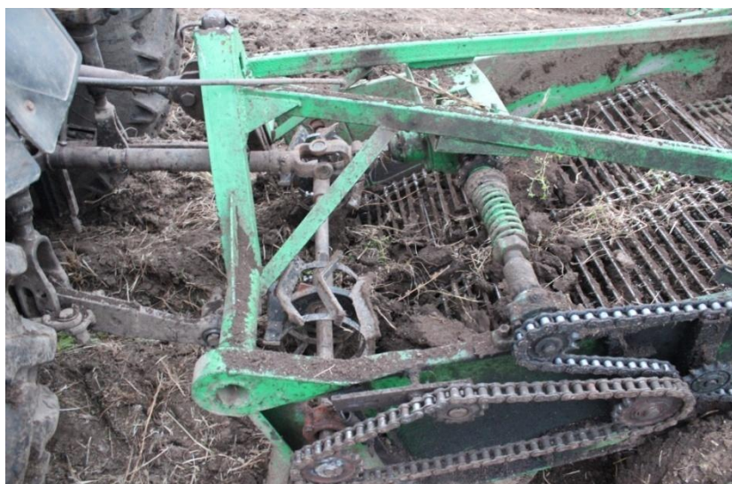
Рисунок 3 – Копатель КТН-2В, оборудованный рыхлителем
