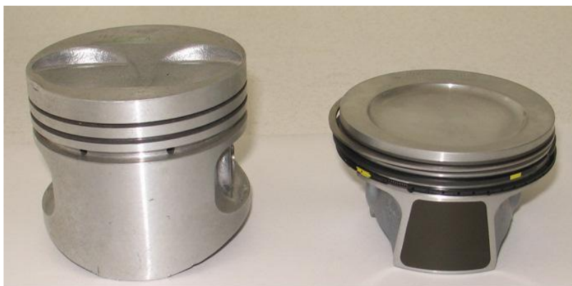
Рисунок 1 – Поршни бензинового двигателя старого и нового поколений
