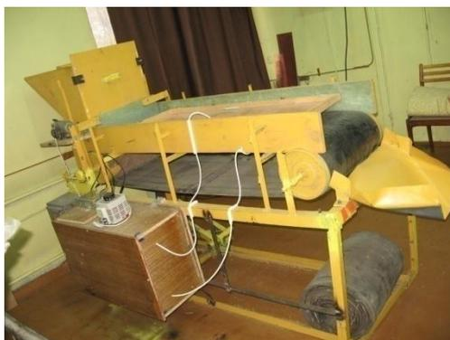
Рисунок 1 – Ленточный электрический многослойный стимулятор семян ЛЭМС
