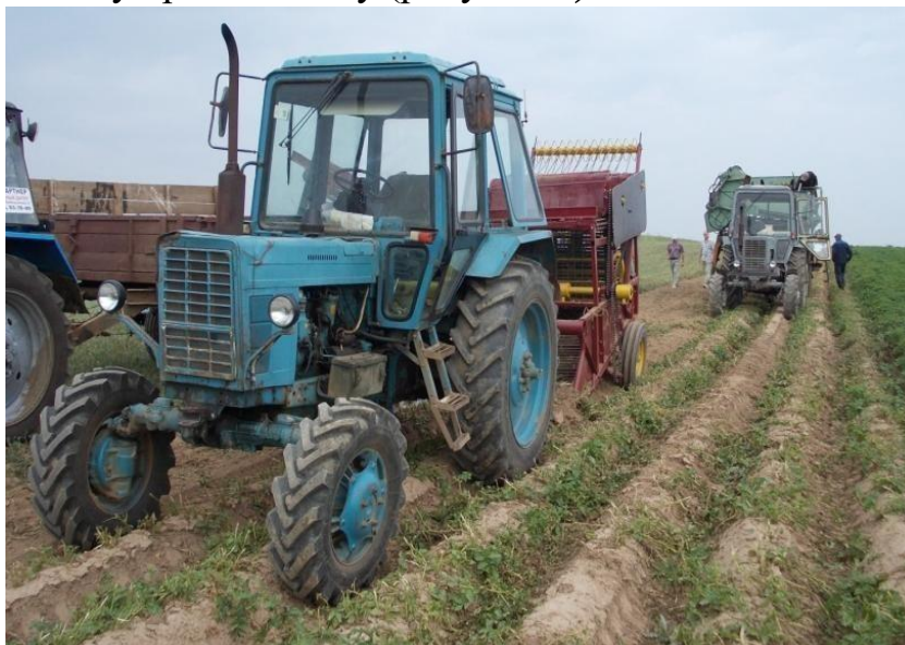
Рисунок 5 – Сравнительные полевые испытания разработанного двухрядного копателя-сборщика картофеля КСК-2М и серийного комбайна КПК-2
