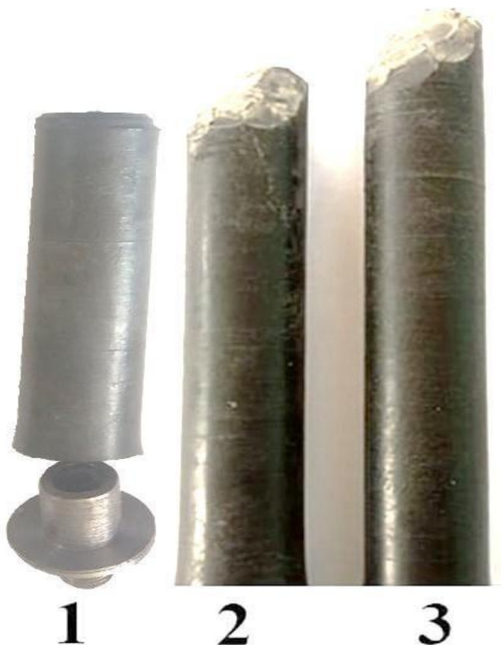
Рисунок 3 – Общий вид изношенных пальцев:
