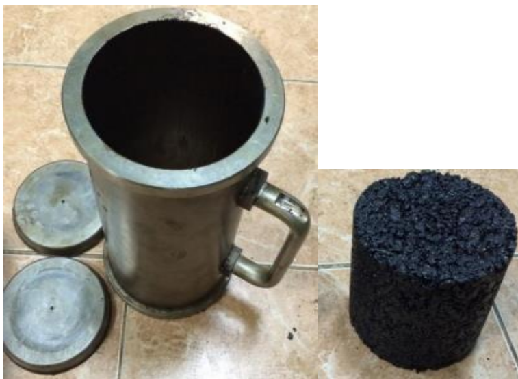
Рисунок 5—Полученный асфальтобетонный образец
