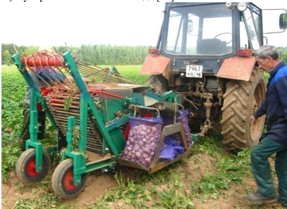
Рисунок 2 – Однорядный копатель-сборщик КСК-1 с загрузкой клубней картофеля в мешки
