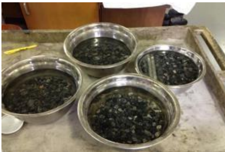
Рисунок 3—Определение плотности и абсорбции
