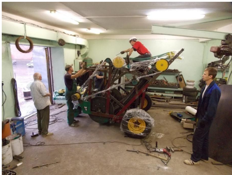
Рисунок 3 –Сборка двухрядного копателя-сборщика картофеля в мастерской СКИБ Ижевской ГСХА
