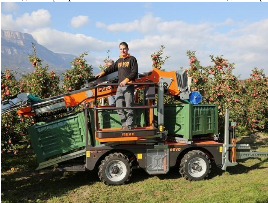
Рисунок 2 – Самоходной плодуборочной платформы RevoPiuma 4WD
