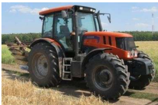
Рисунок 1 – Опытный пахотный агрегат АТМ 3180 «Terrion» + ПЛН-5-35
