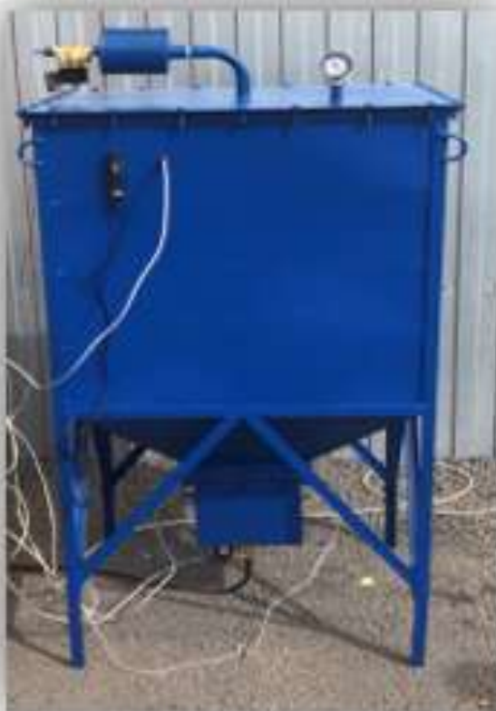
Рисунок 2 – Вид установки герметичного контейнера с разряженной средой
