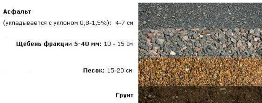
Рисунок 1 – Технологическая схема дорожной одежды
