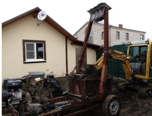
Рисунок 3 - Загрузка кузова multifunctional транспортно-погрузочного средства с помощью мини-экскаватора.
