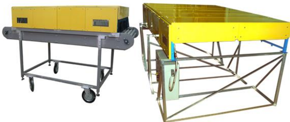
Рисунок 2 - Установка для предпосевной обработки семян ультрафиолетовым излучением
