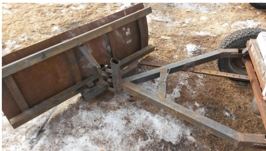
Рисунок 5 - Навесной поворотный отвал на multifункциональном транспортно-погрузочном средстве.
