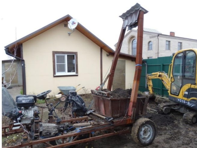
Рисунок 2 - Multifunctional транспортно-погрузочное средство, работающее в паре с мини-экскаватором.
