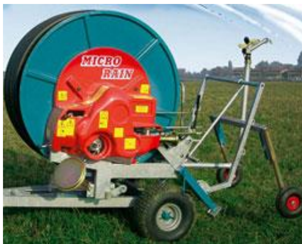
Рисунок 1 – модель ирригационной установки Micro Rain
