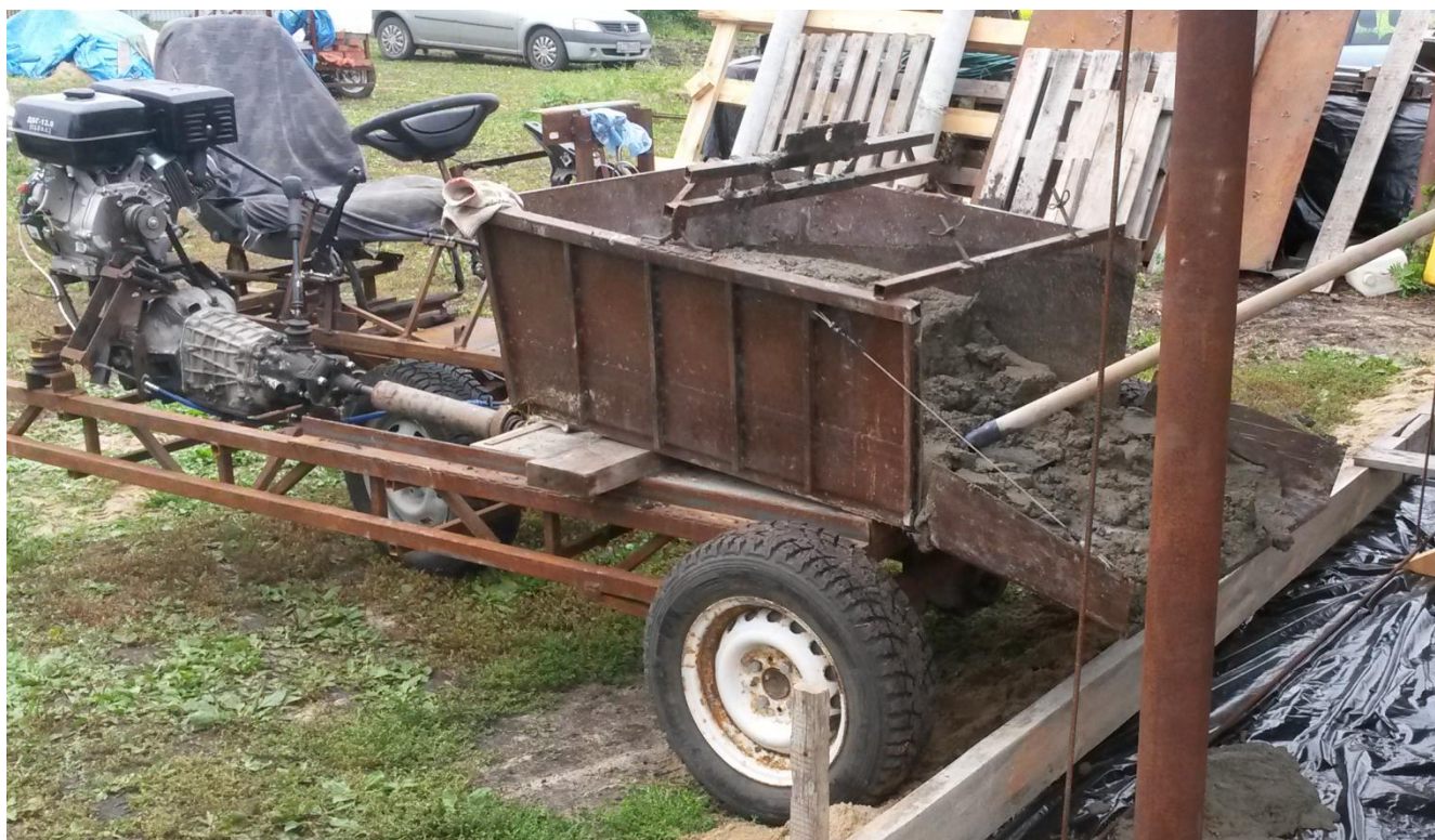
Рисунок 1 – Мультифункциональное транспортно-погрузочное средство, оснащенное кузовом с откидывающимся задним бортом
