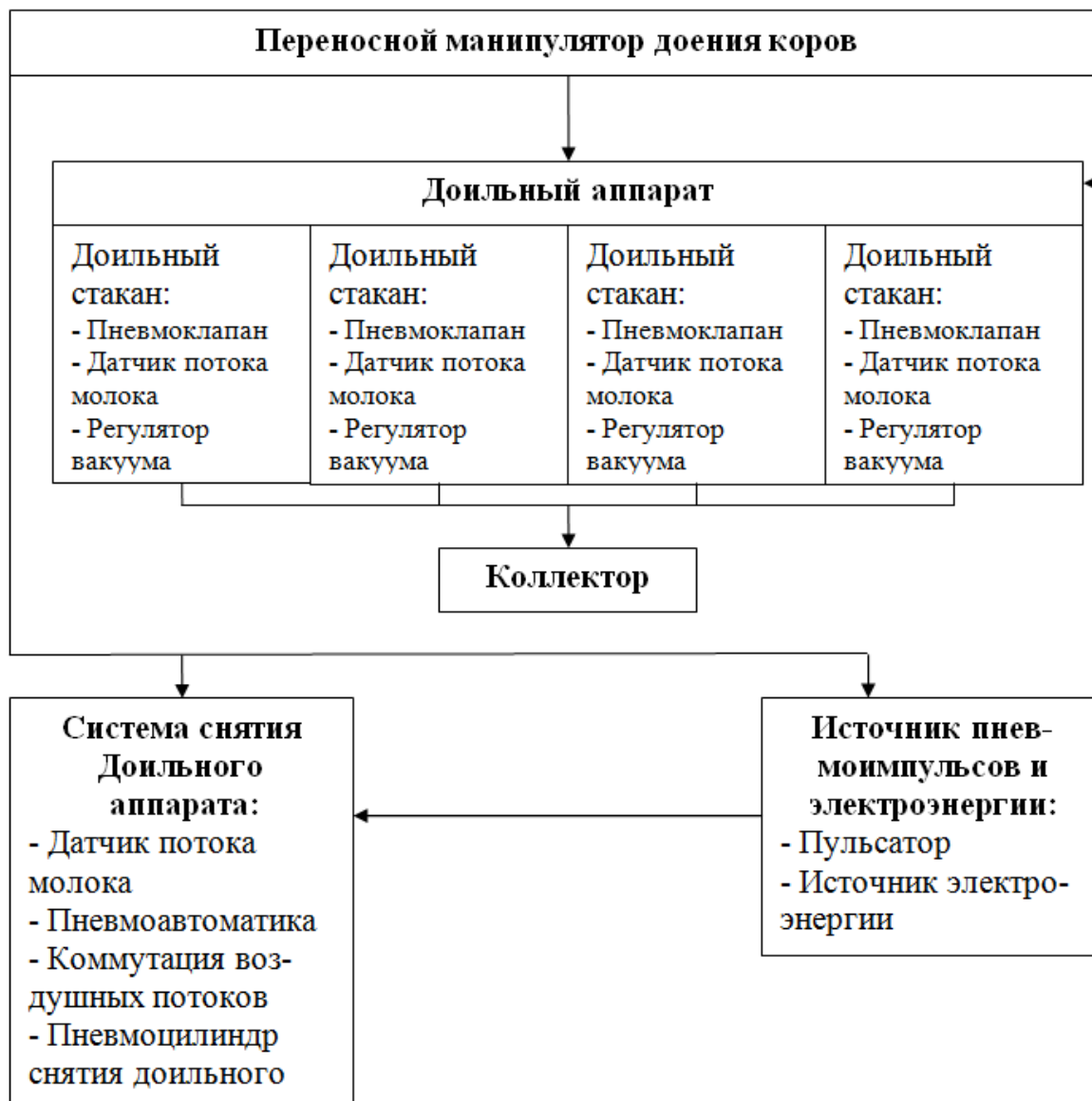
Рисунок 1 - Блок-схема переносного манипулятора доения коров
