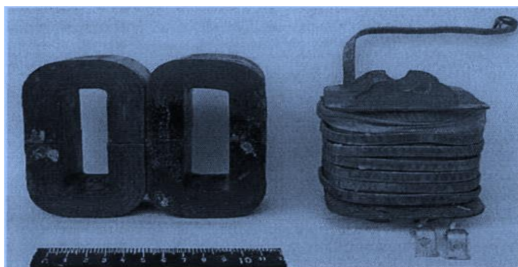
Рисунок 3- Магнитопровод и обмотка автотрансформатора на основе трансформатора ОСМ 1-0,63
