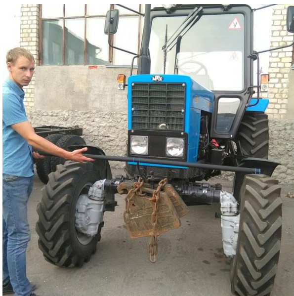
Рисунок 3 – Установка сканирующего устройства на трактор
