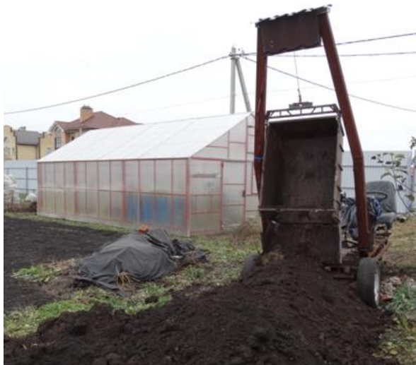
Рисунок 4 - Самосвальная разгрузка кузова multifункционального транспортно-погрузочного средства.
