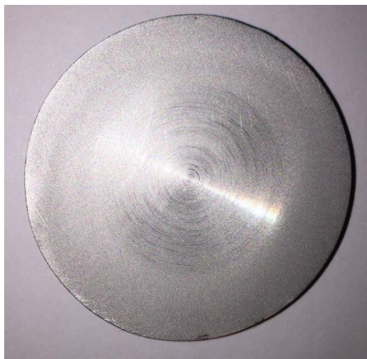
Рисунок 5 – Образец после анодной обработки
