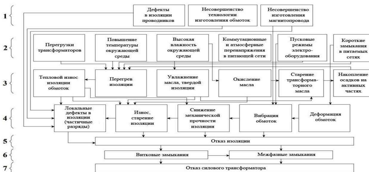
Рисунок 1 – Схема развития повреждений изоляции трансформаторов:
