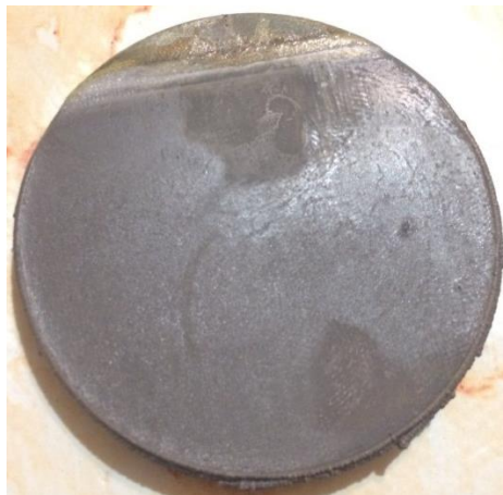
Рисунок 6 – Покрытие, полученное в стандартном электролите
