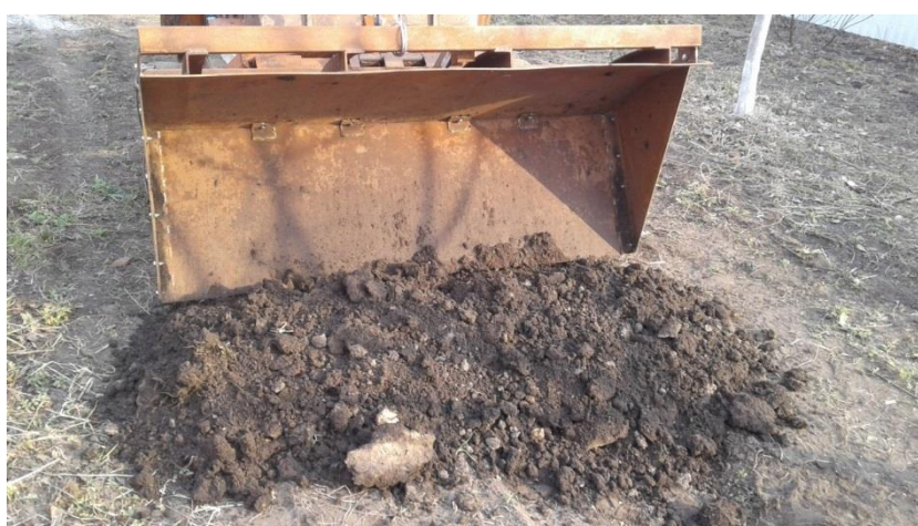
Рисунок 8 - Механизированная разгрузка фронтального ковша multifunctional транспортного-погрузочного средства.
