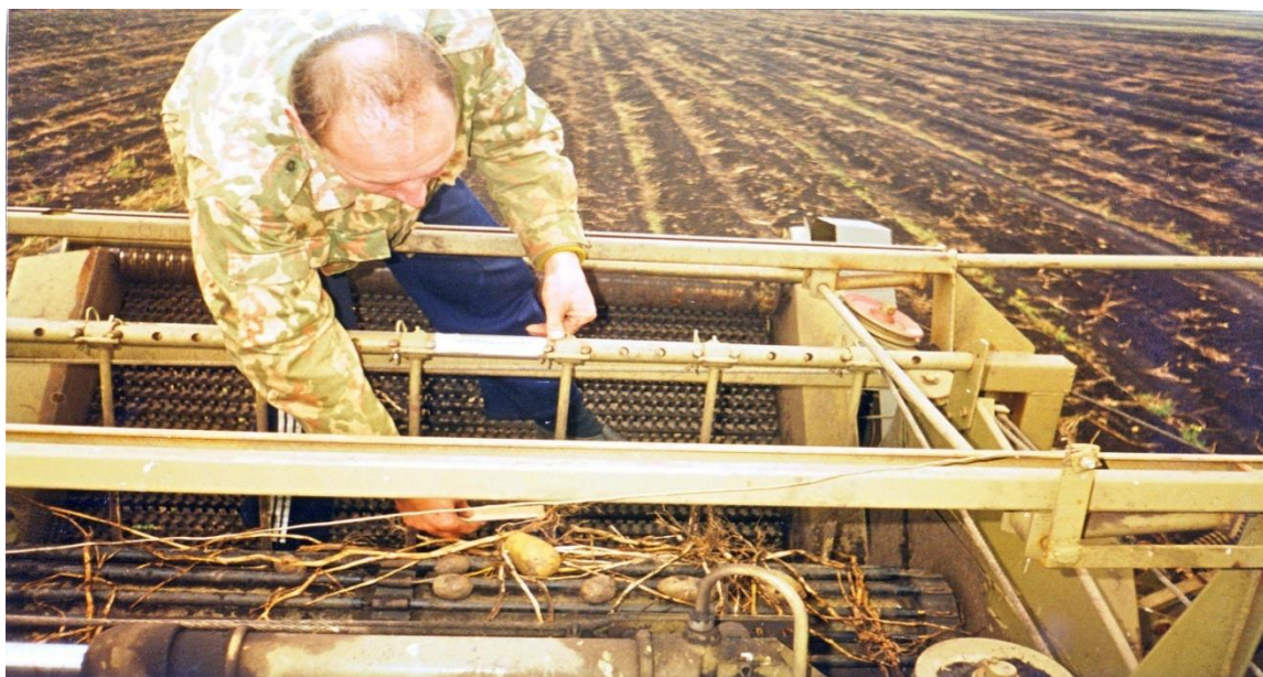
Рисунок 3 – Исследование работы пальчато-гребенчатого ботвоудалителя копателя-погрузчика Е-684
