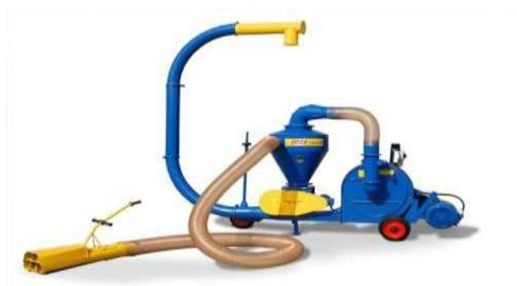
Рисунок 2 – Пневматический транспортер
