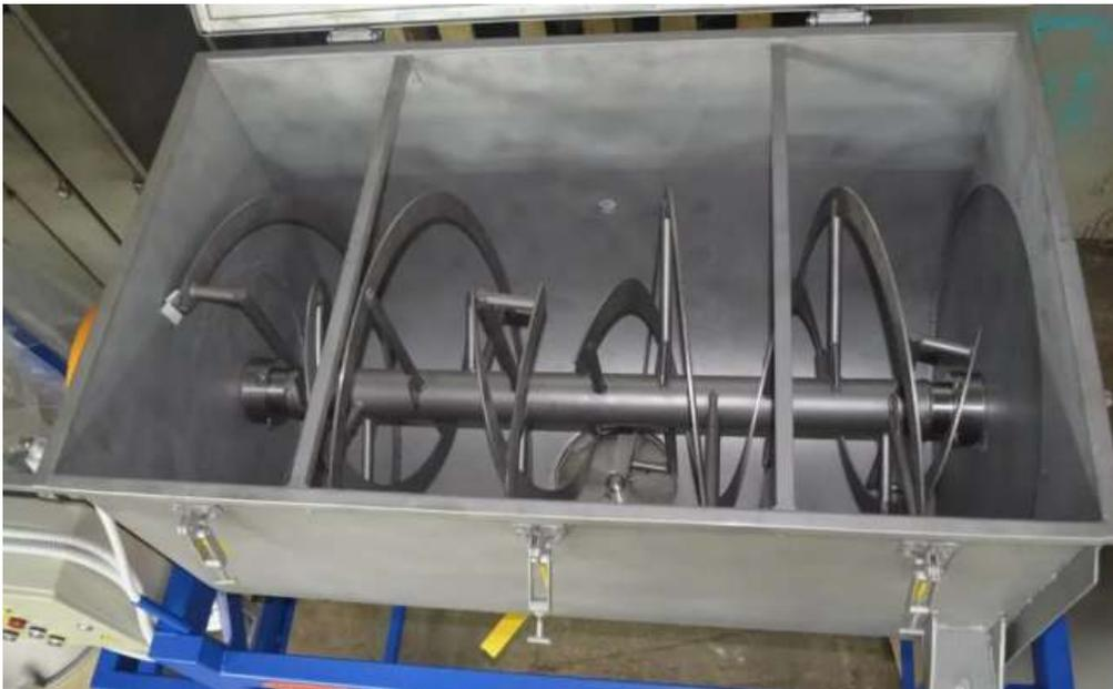
Рисунок 5 – Ленточная мешалка
