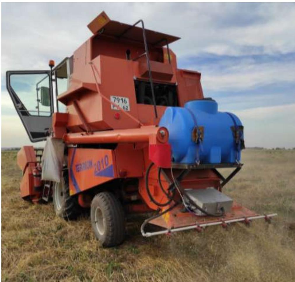
Рисунок 4 – Опытный селекционный зерноуборочный комбайн Terrion-sampro SR2010 оборудованный системой подачи рабочего раствора биопрепарат-деструктора в измельченную солому
