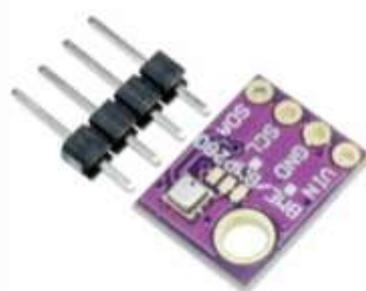
Рисунок 3 – Датчик температуры VME280
