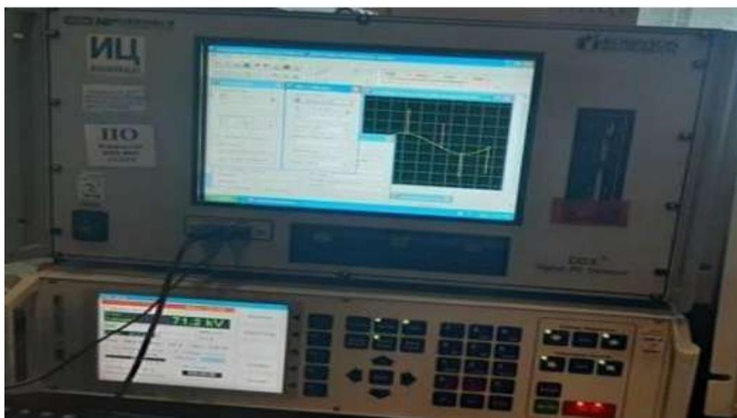
Рисунок 5 – Измеритель ЧР DDX 8003
