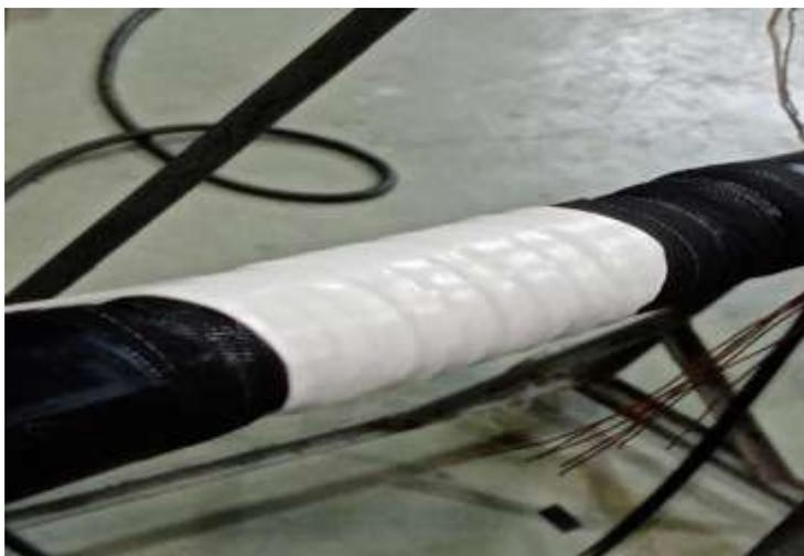
Рисунок 6 –Лента АБРИС КИ–20 на гильзе для выравнивания электрического поле материала
