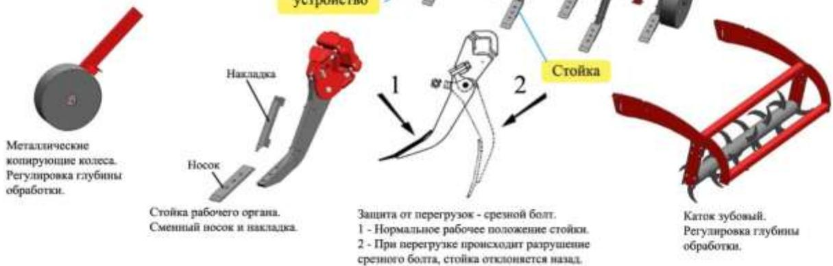
Рисунок 2 – Культиватор-глубококорыхлитель КГР-2,4
