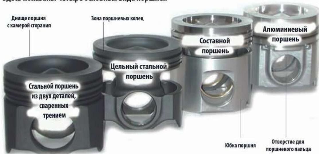
Рисунок 3 – Современные поршни для дизельных двигателей
