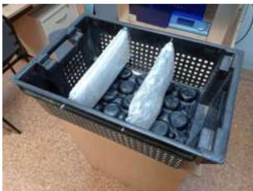
Рисунок 4 – Экспериментальный образец модернизированной тары для транспортировки плодоовощной продукции
