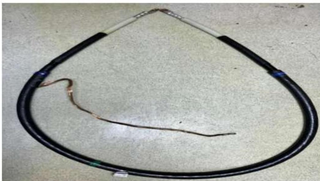
Рисунок 3 – Кабель АПвП 1×95–35 кВ, участвовавший в испытании
