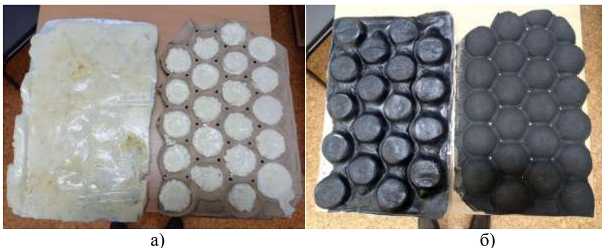
Рисунок 3 – Экспериментальные образцы расположенных в шахматном порядке полых сферических выступов демпфирующей накладки из пеностирола со сплошной заливкой монтажной пеной (слева) и из картона с точечной заливкой монтажной пеной (справа): а) нижняя сторона накладок; б) верхняя сторона накладок
