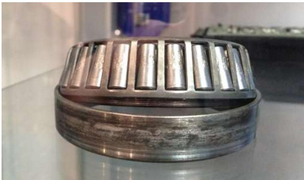
Рисунок 2 – Абразивный износ подшипника
