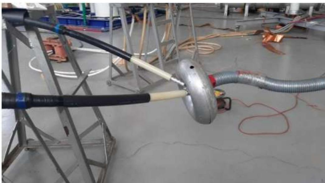
Рисунок 4 – Подключение кабеля к источнику напряжения MSR–600 и измерителю ЧР DDX 800
