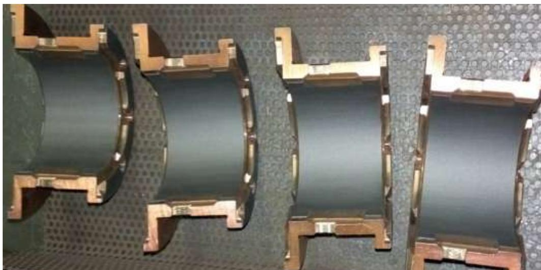
Рисунок 3 – Элементы трения в узлах сельскохозяйственной техники, покрытые твердой смазкой
