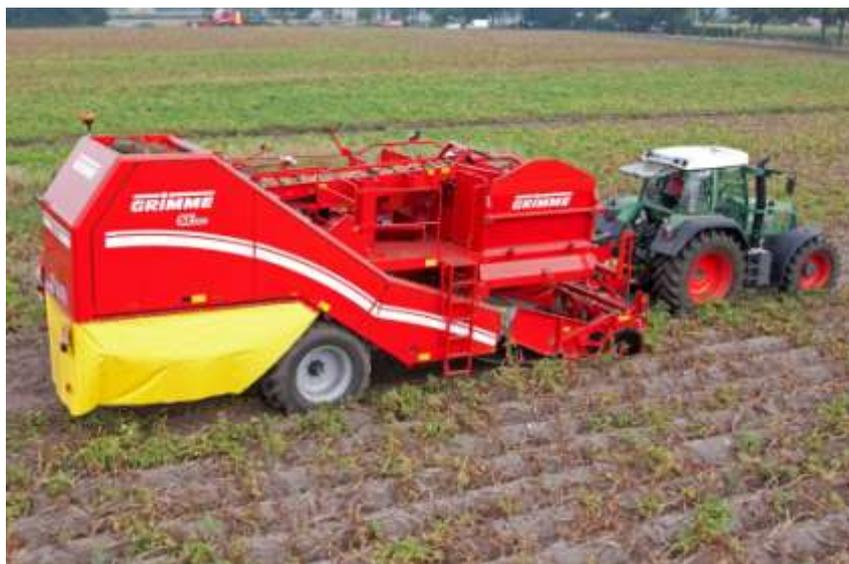
Рисунок 1 – Прицепной картофелеуборочный комбайн Grimme SE260
