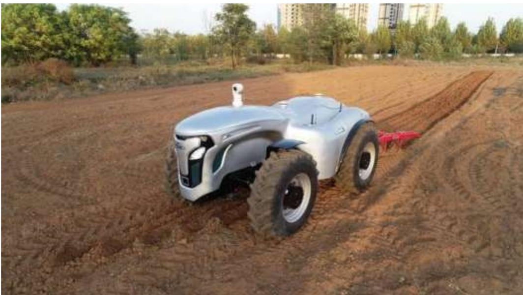
Рисунок 4 – Электрический трактор без водителя под управлением g-модуля
