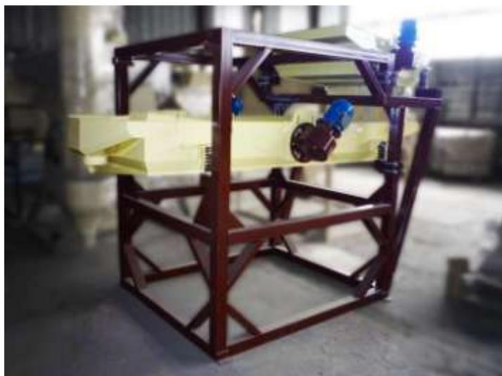
Рисунок 2 – Очищающе-калибрующая машина (ОКМФ)
