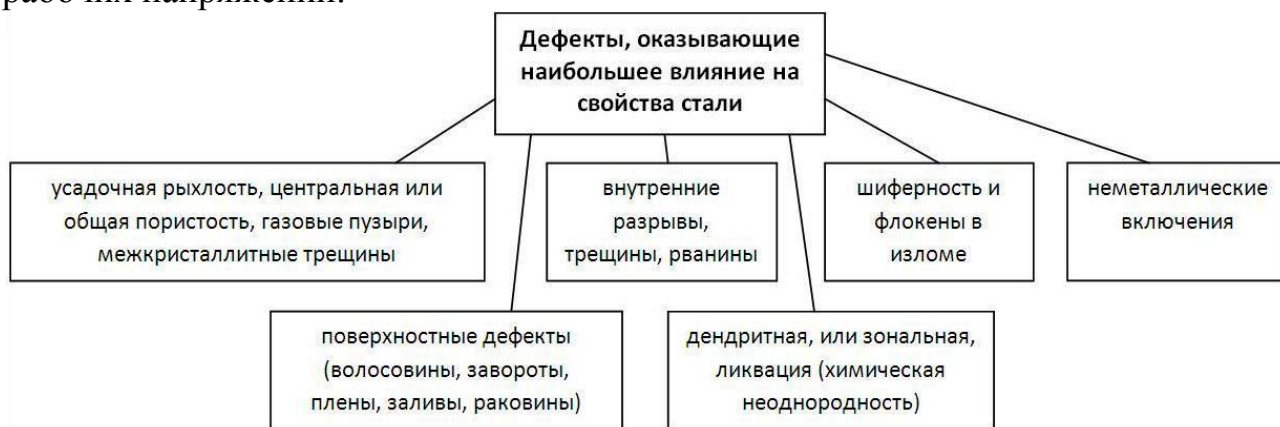
Рисунок 1 – Основные дефекты, оказывающие наибольшее влияние на свойства стали
