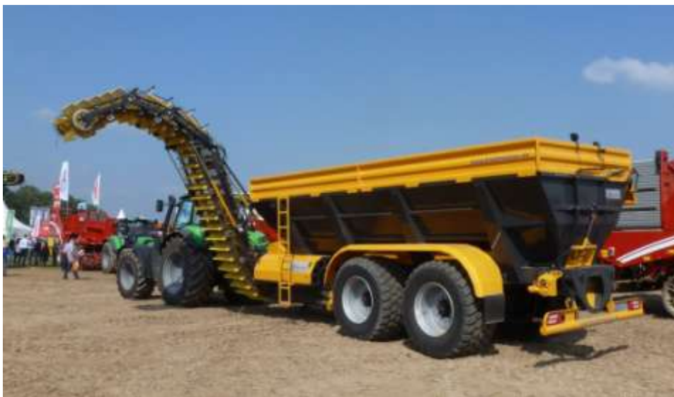
Рисунок 1 – Прицеп с сепаратором почвы в его передней части Brettmeister КЗ фирмы Josef Brettmeister Metall- und Fahrzeugbau
