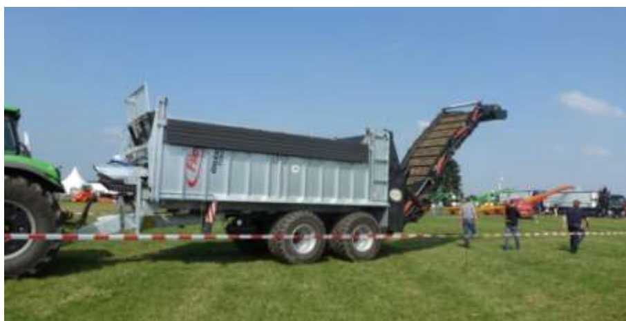
Рисунок 2 - Прицеп с сепаратором почвы в его задней части фирмы Fliegl Agrartechnik GmbH
