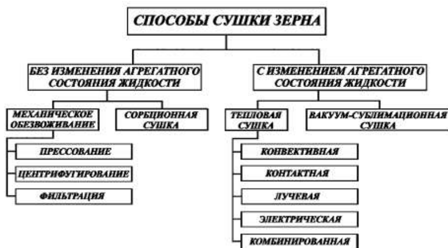
Рисунок 2 – Классификация способов сушки зерна
