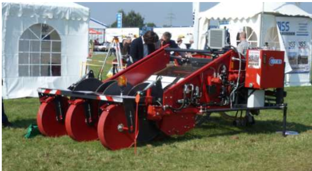
Рисунок 3 – Двухрядный навесной копатель для комбинированной уборки картофеля фирмы TOLMAC (Нидерланды)
