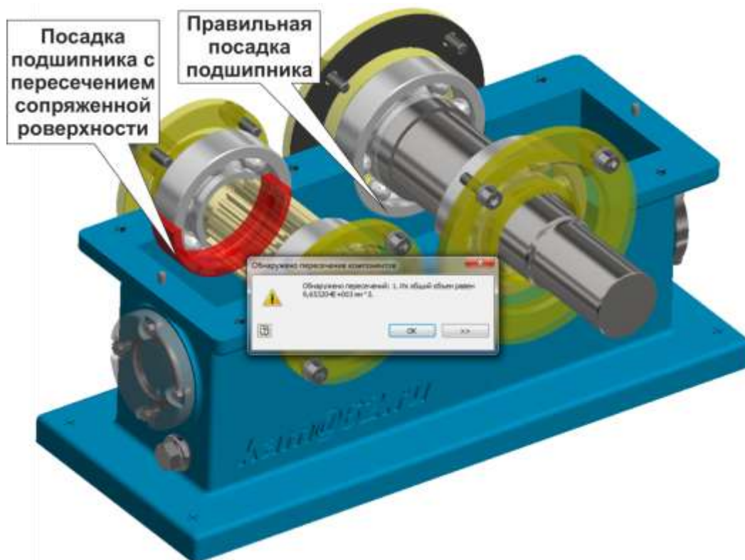
Рисунок 1 – Пример осуществления автоматической проверки пересечений статических деталей
