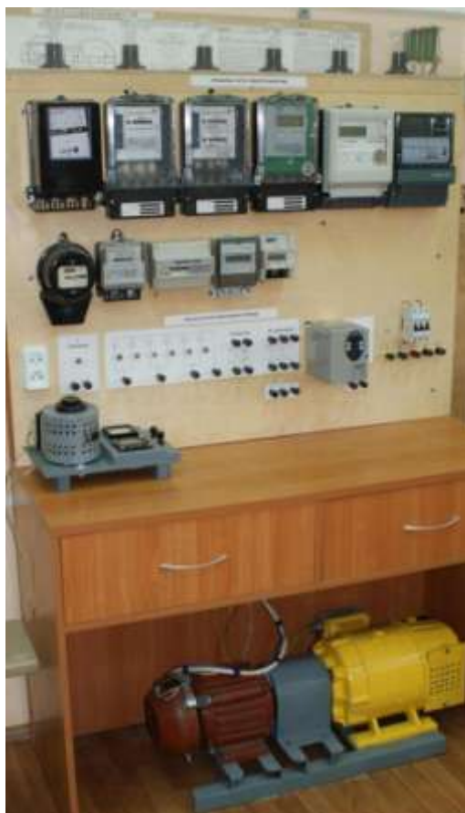
Рисунок 2 – Внешний вид стенда для испытания частотного преобразователя с двигатель – тормозной установкой
