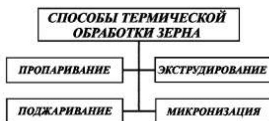
Рисунок 3 – Способы термической обработки зерна
