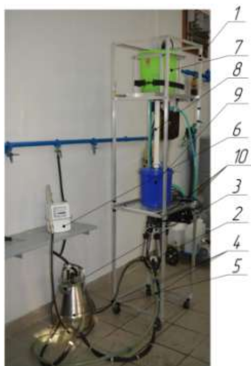
1 – искусственное вымя; 2 – подвесная часть доильного аппарата; 3 – пульсатор; 4 – шланги; 5 – доильное ведро; 6 – счетчик газа; 7 – бак для жидкости; 8 – напорная труба; 9 – расширительная емкость; 10 – имитаторы сосков.
