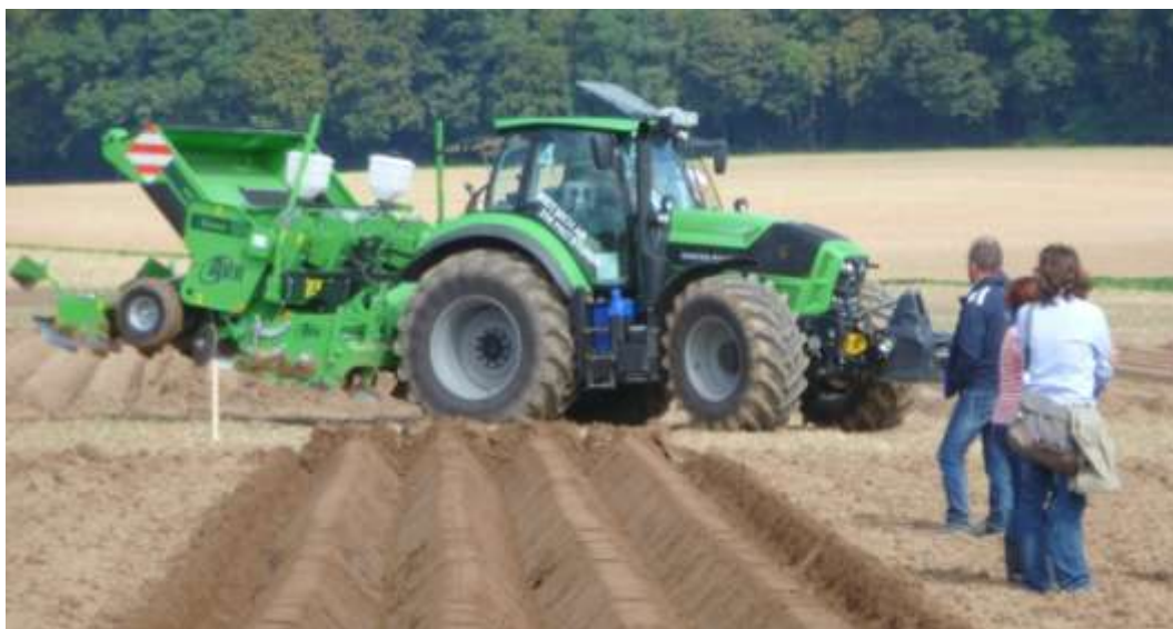
Рисунок 1 – Комбинированный агрегат для подготовки почвы и посадки картофеля фирмы AVR
