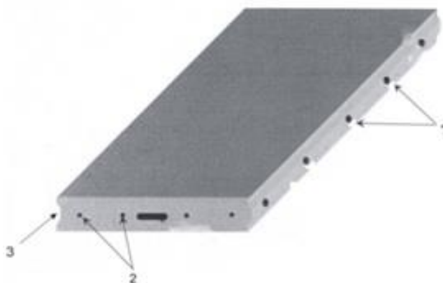
Рисунок 1 - Дорожная плита из преднапряженного бетона для укладки по технологии ИМЭТ:
