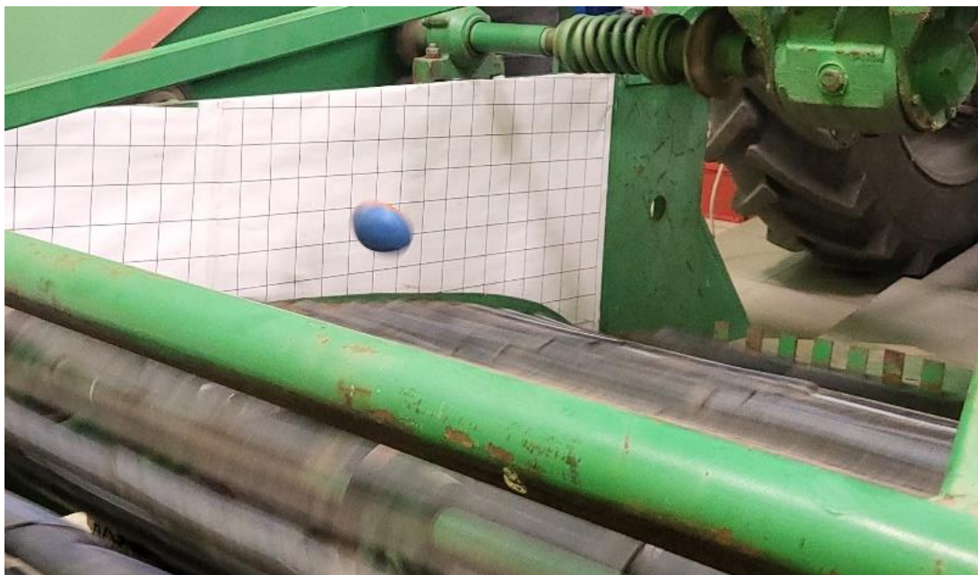
Рисунок 3.3 – Полет электронного клубня «Tuber-Log» при исследовании динамического воздействия элеваторов с активными встряхивателями
