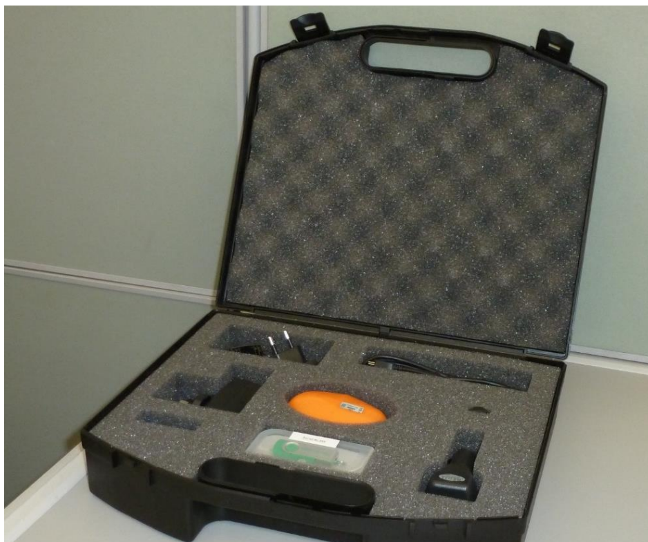
Рисунок 3.2 Электронный клубень «Tuber-Log»
