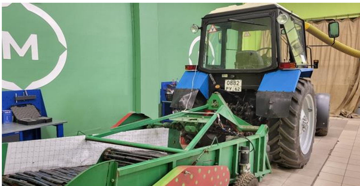
Рисунок 3.1 – Общий вид экспериментальной установки - элеватора с адаптивными встряхивателями.
