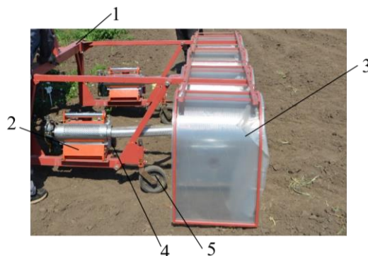
1 – рама; 2 – генератор горячего тумана, 3 – тоннельные укрытия; 4 – резервуар для рабочего раствора; 5 – опорное колесо
