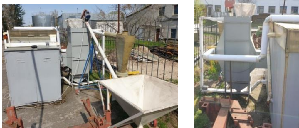
Рисунок 5 – Общий вид модульной сушилки аэродинамического нагрева с загрузочным транспортером
