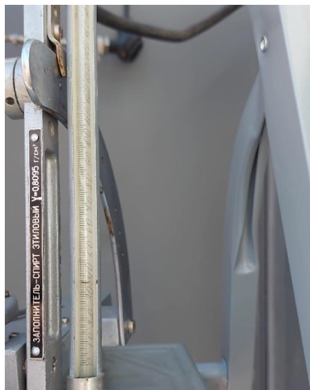
Рисунок 3.27 - Измерение избыточного давления на входе в сушильную шахту
