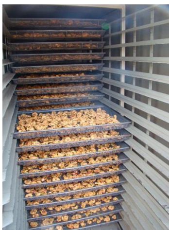
Рисунок 2.1 - Сушильная камера, заправленная нарезанными яблоками
