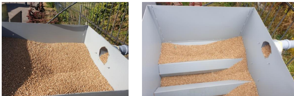
Рисунок 4.7 – «Характер истечения зерна из сушильной шахты» [60]
