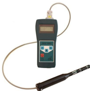
Рисунок 3.28 – Измерение параметров метеометром МЭС-200
