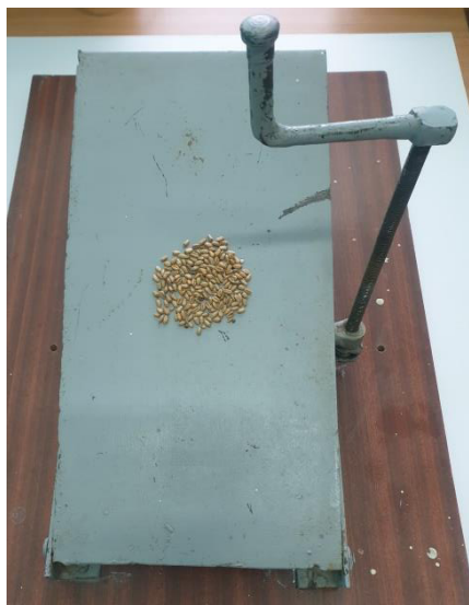
Рисунок 4.2 – Определение угла внешнего трения
