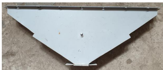
Рисунок 3.14 – «Нижний бункер беспроводного выпускного устройства» [60]
