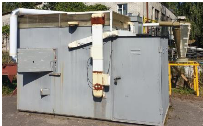
Рисунок 3.5 – Модульная сушилка аэродинамического нагрева [18]
