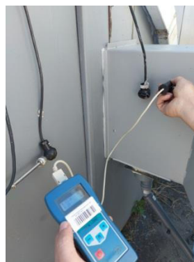
Рисунок 3.28 – Измерение параметров метеометром МЭС-200
