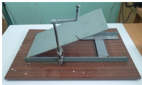
Рисунок 3.4 – Площадка с регулируемым наклоном
