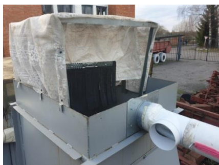
Рисунок 3.21 – Общий вид зерно-отбойного фартука с фильтрующим ограждением
