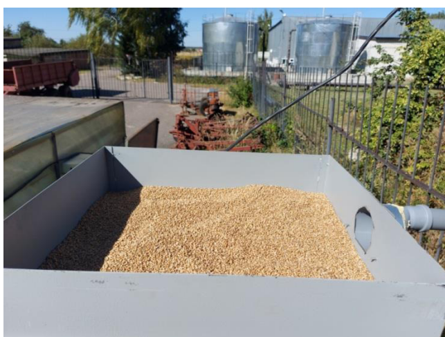
Рисунок 3.9 – Загрузочный зерновой бункер сушильной шахты
