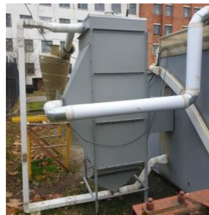
Рисунок 3.5 – Модульная сушилка аэродинамического нагрева [18]
