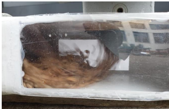
Рисунок 4.29 – Работа пневмотранспортера с защитной вставкой в выпуске
