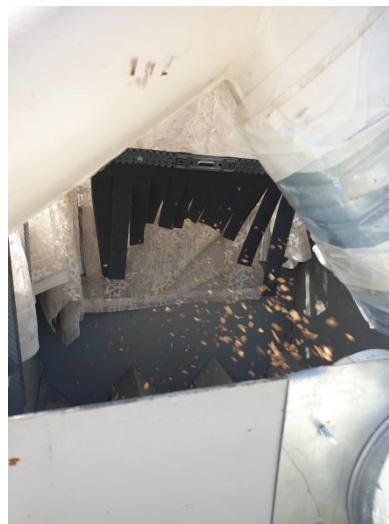
Рисунок 4.30 – Работа зерно-отбойного фартука с фильтрующим ограждением
