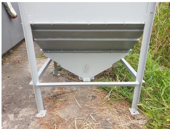
Рисунок 3.11 – Бесприводное выпускное устройство сушильной шахты
