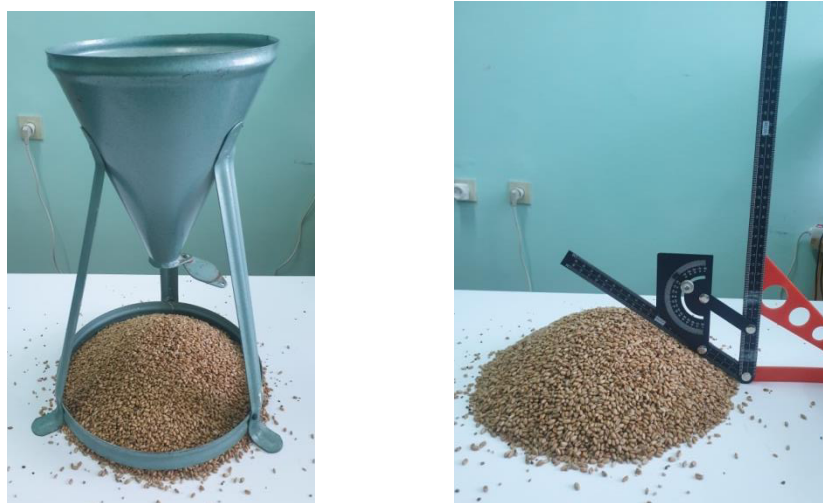
Рисунок 4.1 – Определение угла естественного откоса
