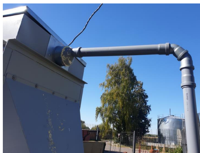
Рисунок 3.9 – Загрузочный зерновой бункер сушильной шахты
