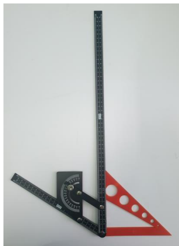
Рисунок 3.3 – Оборудование для определения угла естественного откоса: а – воронка с задвижкой [97]; б - транспортер с параллелограммным механизмом
