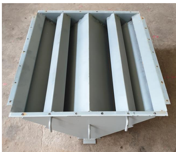
Рисунок 3.13 – «Верхний бункер беспроводного выпускного устройства» [60]
