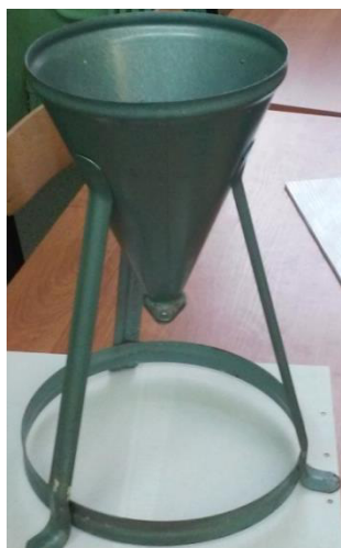
Рисунок 3.3 – Оборудование для определения угла естественного откоса: а – воронка с задвижкой [97]; б - транспортер с параллелограммным механизмом
