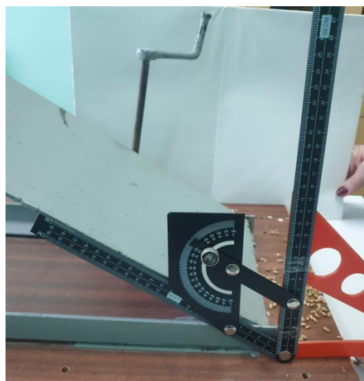
Рисунок 4.2 – Определение угла внешнего трения
