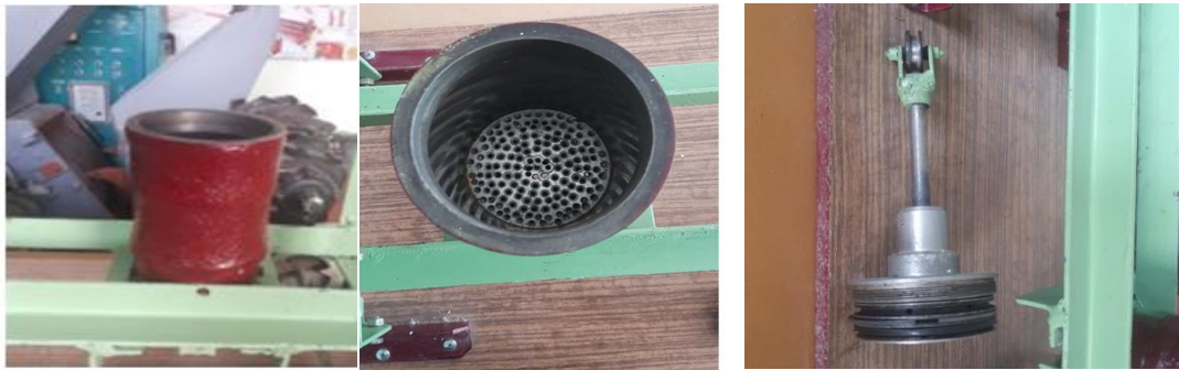
Рисунок 2.6 – Цилиндрическая камера с поршнем
