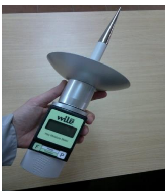
Рисунок 2.2 – Общий вид влагомера сена, сенажа и силоса ВАЙЛ 26 (WILE 26)
