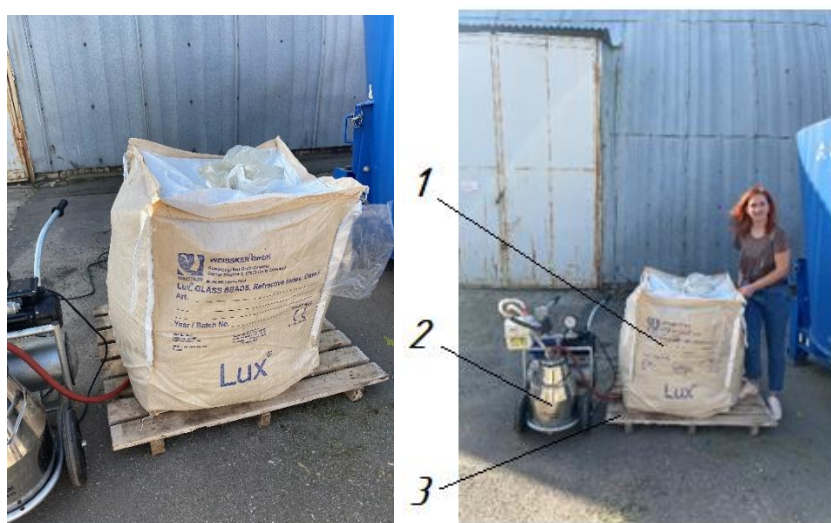
1 – контейнер; 2 – вакуумная установка; 3 – поддон Рисунок 5.1 – Общий вид производственной установки
