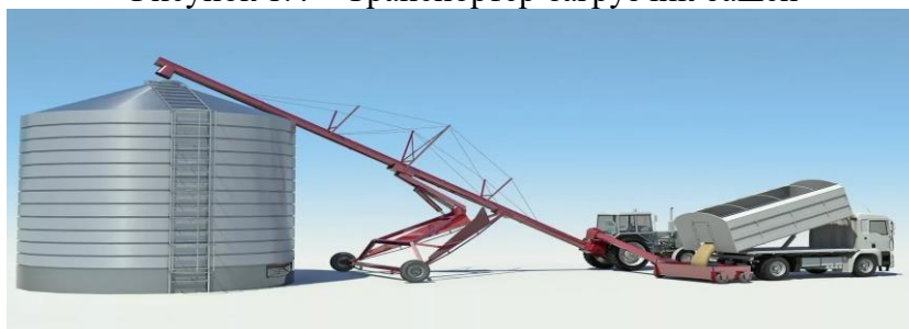
Рисунок 1.5 – Схема загрузки корма при силосовании в башнях
