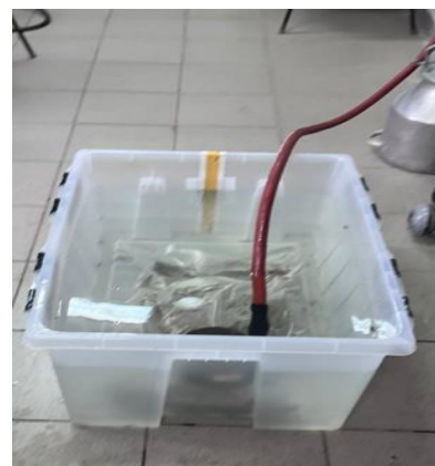
Рисунок 4.8 - Мягкий контейнер в резервуаре после вакуумирования
