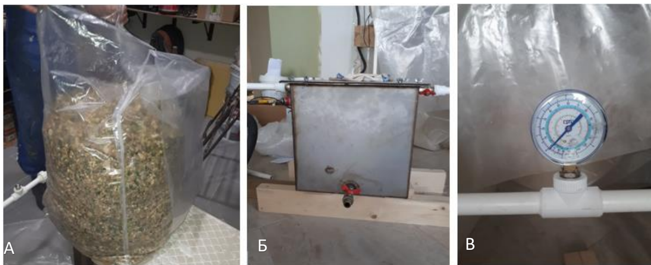
а) мягкий контейнер с силосуемой массой; б) вакуумный баллон; в) вакуумметр
