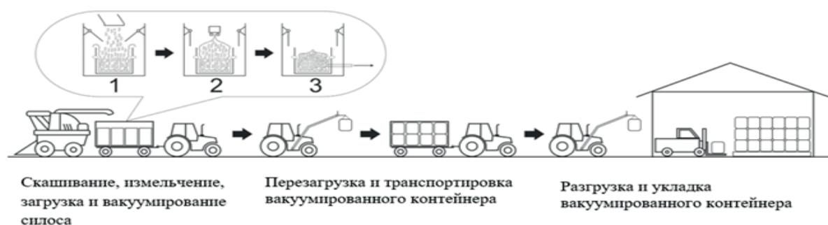
Рисунок 1.16 – Операции, входящие в технологию приготовления и хранения силоса в мягких вакуумированных контейнерах путем вакуумирования» [78]
